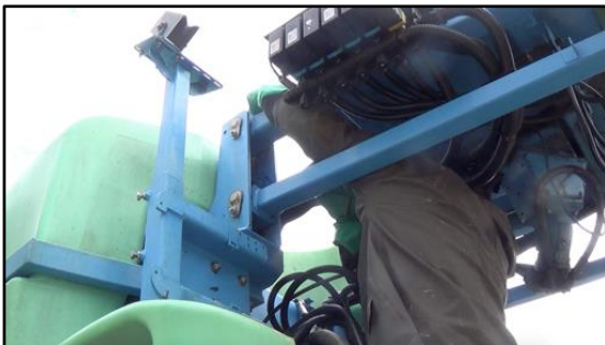
Figure 93 – Graissage du pulvérisateur (2)
