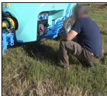
Figure 59 – Arrêt de la vanne de brassage (1)
