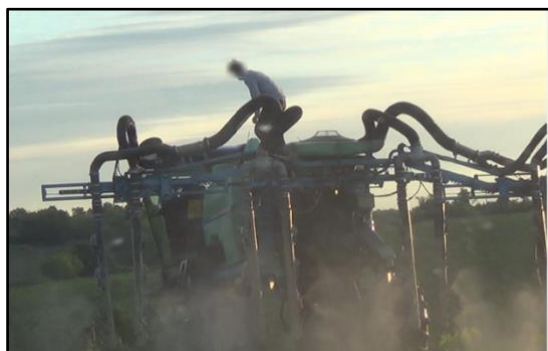
Figure 70 – Vérification du fonctionnement de la pulvérisation en montant sur la cuve
