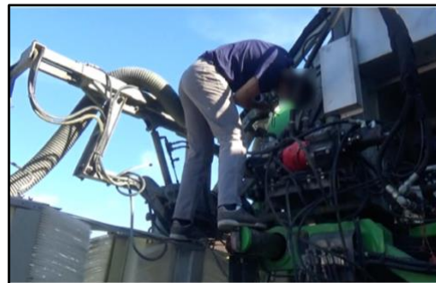
Figure 94 – Intervention sur le matériel pour retirer le capteur GPS (2)
