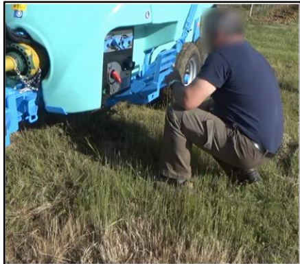
Figure 92 – Arrêt de la vanne de brassage (2)
