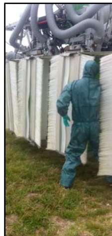
Figure 9 – Action sur une buse bouchée
