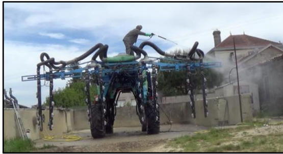
Figure 75 – Passage du karcher sur les surfaces supérieures du pulvérisateur
