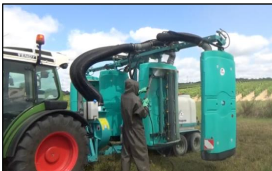
Figure 74 – Passage du karcher à l'intérieur des panneaux récupérateurs
