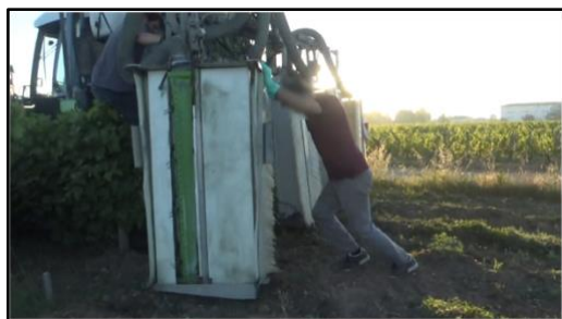
Figure 66 – Retrait de la sécurité automatique en poussant les panneaux récupérateurs
