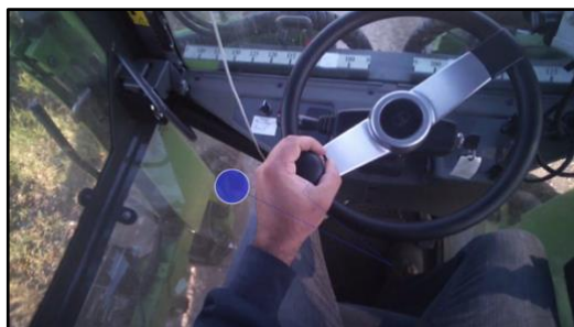
Figure 73 – Vérification du positionnement du pulvérisateur dans le rang en regardant les traces de pneus
