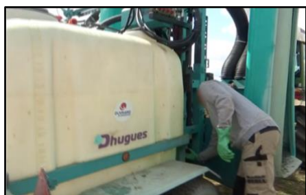
Figure 60 – Arrêt de la vanne de retour en cuve
