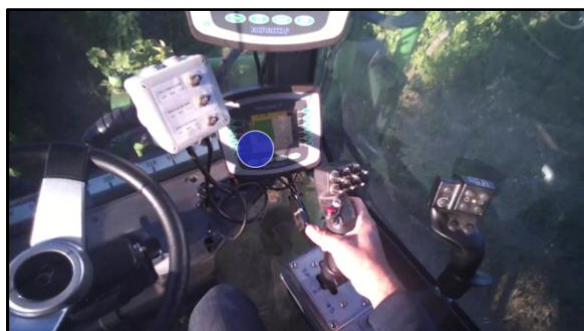
Figure 56 – Contrôle sur l'écran de la fermeture de la pulvérisation dans les tournières
