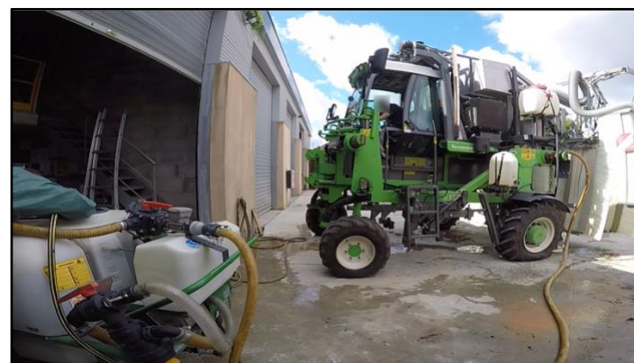
Figure 27 – Incorporation des produits à l'aide d'un incorporeur branché à la cuve du pulvérisateur
