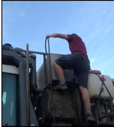
Figure 41 – Insertion du tuyau d'eau dans la cuve du pulvérisateur
