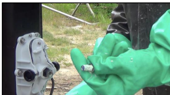
Figure 81 – Colmatage des produits au niveau des buses
