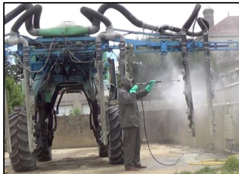
Figure 77 – Nettoyage des surfaces inférieures du pulvérisateur
