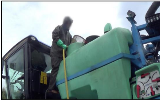
Figure 45 – Utilisation du tamis pour bloquer le tuyau d'eau lors du remplissage
