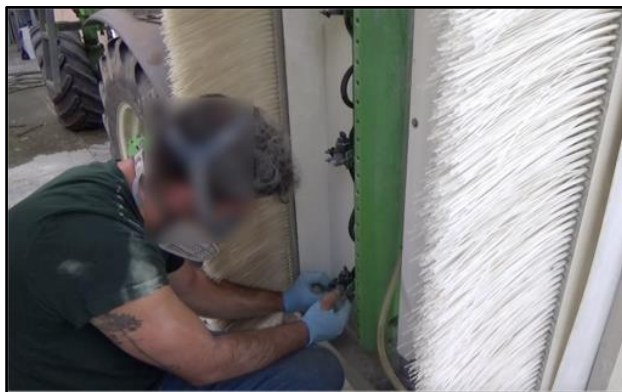
Figure 42 – L'agriculteur remet les filtres et les buses sur les descentes à l'intérieur des panneaux récupérateurs
