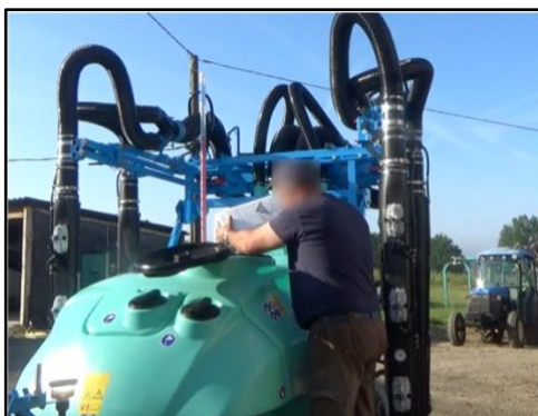
Figure 38 – Déversement des produits dans la cuve
