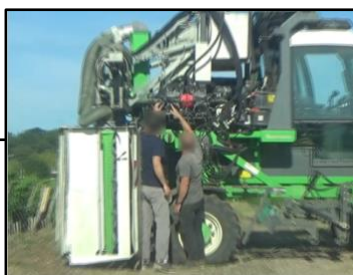
Figure 64 – Intervention sur le matériel pour vérifier l'état du capteur GPS
