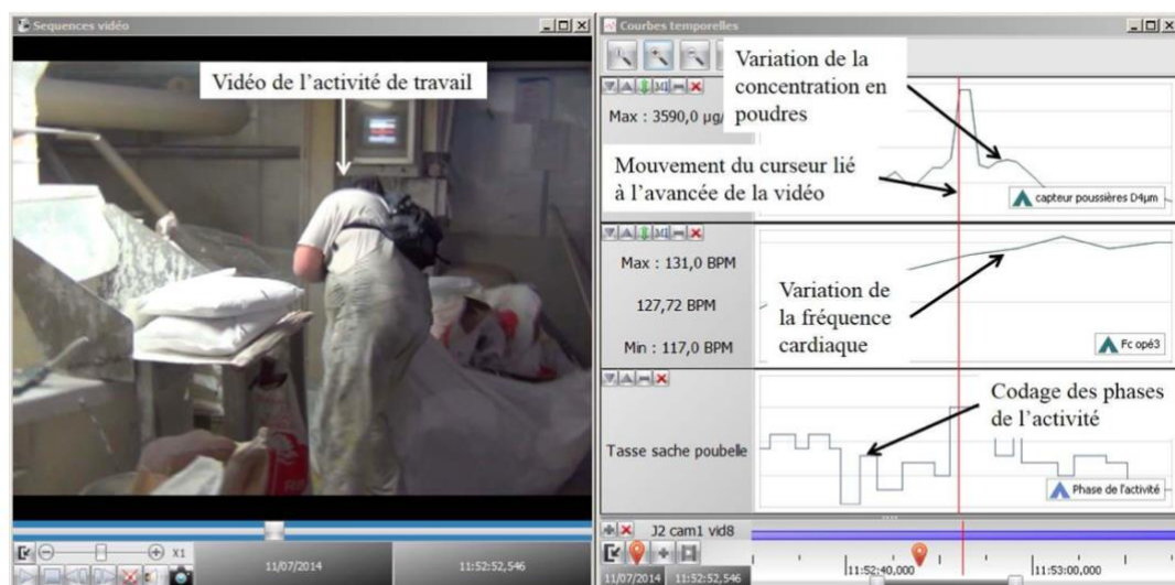
Figure 20 – Capture d'écran du logiciel CAPTIV illustrant une tâche de tassage de sac réalisé par un opérateur dans l'entreprise de peinture routière et une augmentation associée de l'exposition (Galey et al. , 2019, p. 10)
