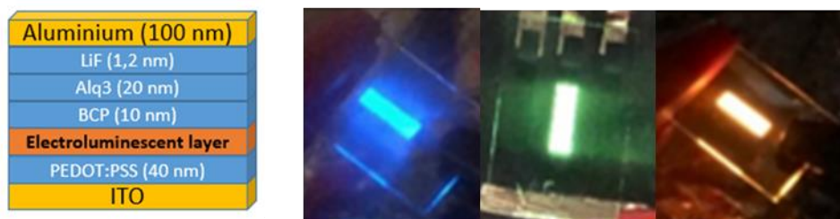
Figure 129 : Architecture OLED et photographie des dispositifs à nanohybrides avec les ligands 40 (gauche), 41 (milieu) et 45 (droite) en fonctionnement. Illustration de Jonathan Phelipot.
