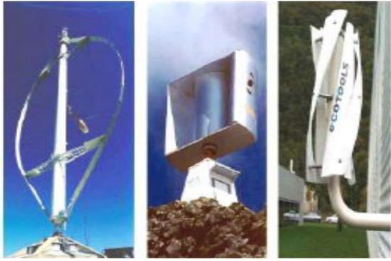
Figure. 4. 2: Eoliennes à axe vertical [HAC 12]
