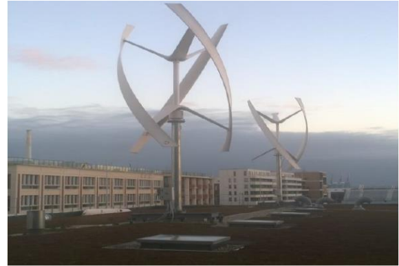
Figure. 4. 3: Eoliennes à axe vertical au laboratoire GREAH Le Havre [ASH 19]
