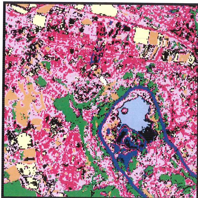
B) IMAGE XS 99, "Classification supervisée (XS1, XS2, XS3), règle de Bayes avec rejet à 0,15 %".
