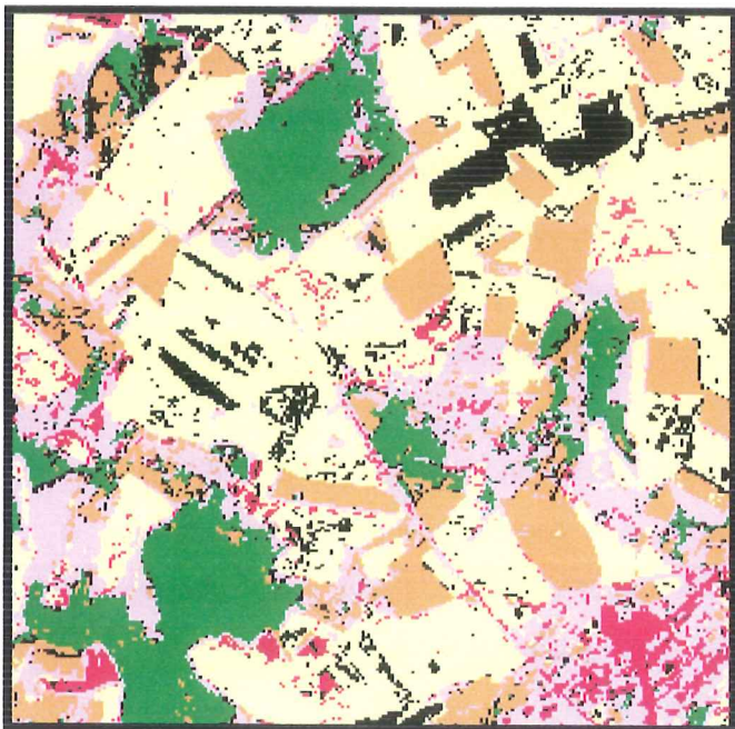
C) IMAGE XS 99, "Classification supervisée (XS1, XS2, Indice de végétation), règle de Bayes avec rejet à 0,15 %".
