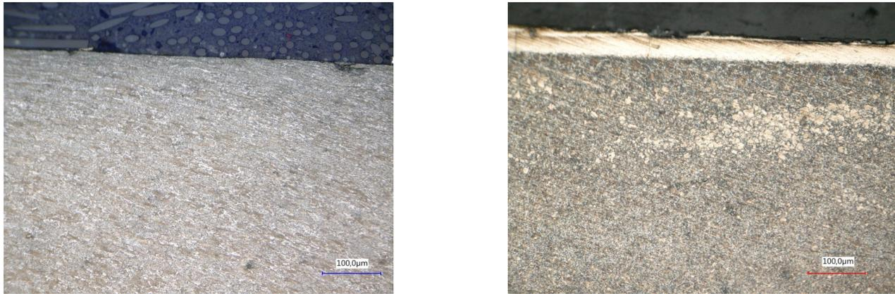
FIGURE I.9 – Écrouissage généré lors de l'utilisation d'une roue ferroviaire. Sur l'image de droite, une transformation tribologique superficielle liée à une augmentation de température faisant suite à un freinage est apparue. Cette phase est qualifiée de "Phase blanche" et est à l'origine de défauts métallurgiques fissurant associés aux roues et rails ferroviaires [15].
