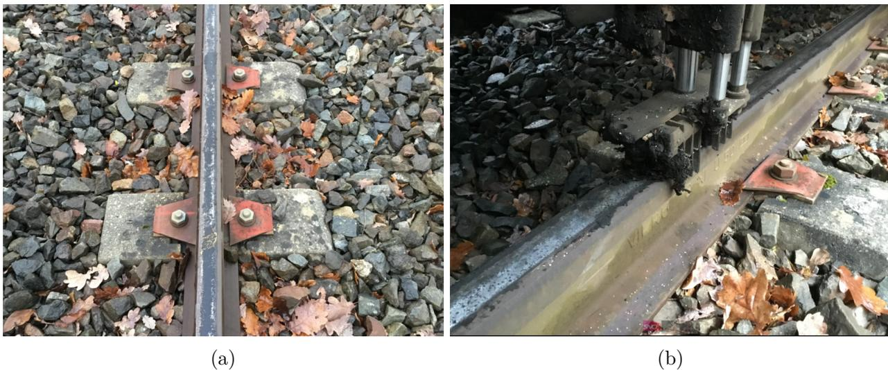
FIGURE II.25 – a) Troisième corps externe polluante retrouvée sur la zone après arrêt des circulations. b) Brosses servant au nettoyage de la surface des rails après passage sur la zone polluée. Les lames métalliques des brosses sont encrassées d'un troisième corps réduisant l'adhérence maximale des trains.
