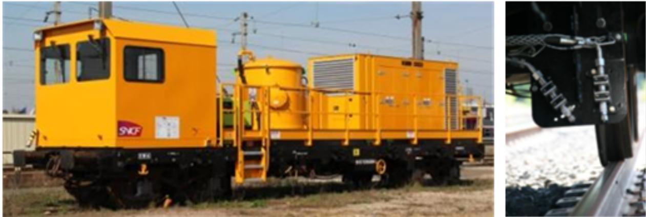
FIGURE I.38 – Aperçu d'un wagon nettoyeur de rail à haute pression (1000 bars).
