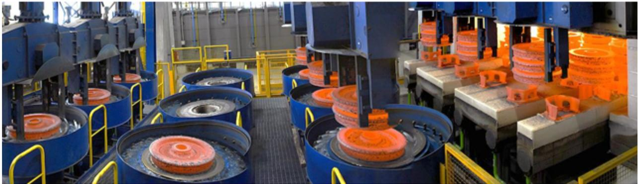
FIGURE 22 – Trempe d'une roue en sortie d'un four d'austénitisation [139].
