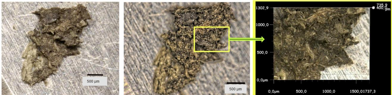
FIGURE II.31 – Observation de l'échantillon 2 par microscopie optique. Les grossissements sont (de gauche à droite) de x50, x50 + HDR, et x200.
