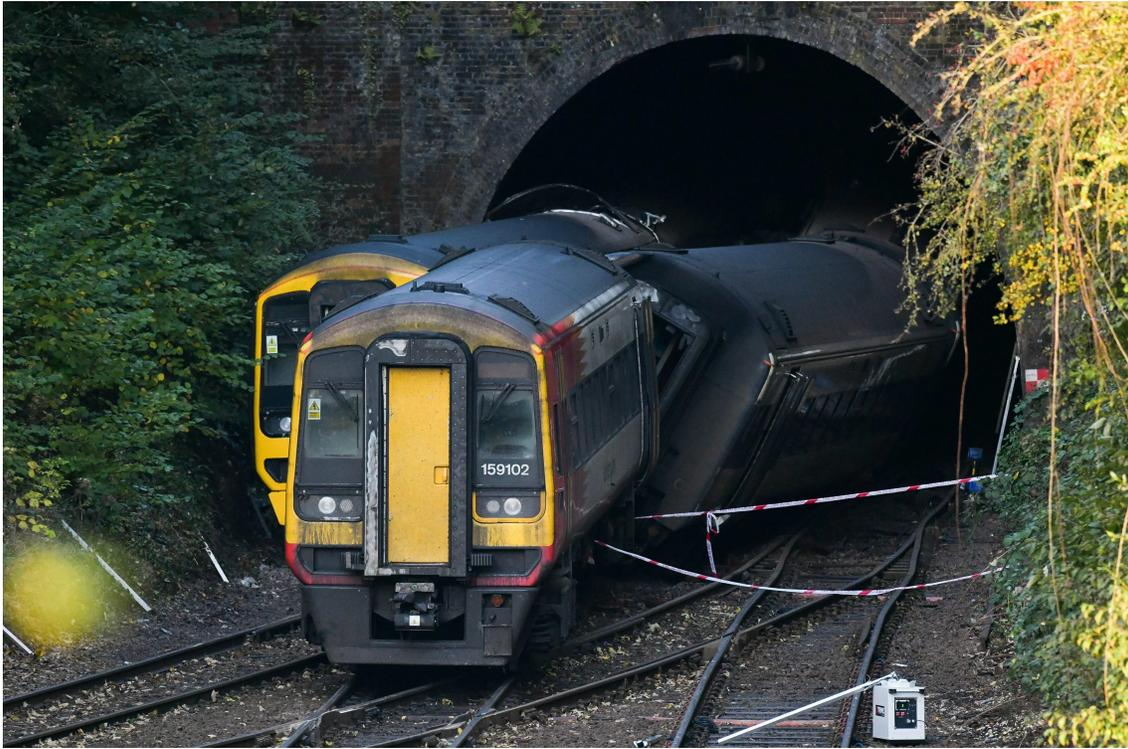
FIGURE I.37 – Collision entre deux trains à Salisbury le 31/10/2021 due à la présence de feuilles mortes sur les rails dégradant leurs capacités de freinage [46].
