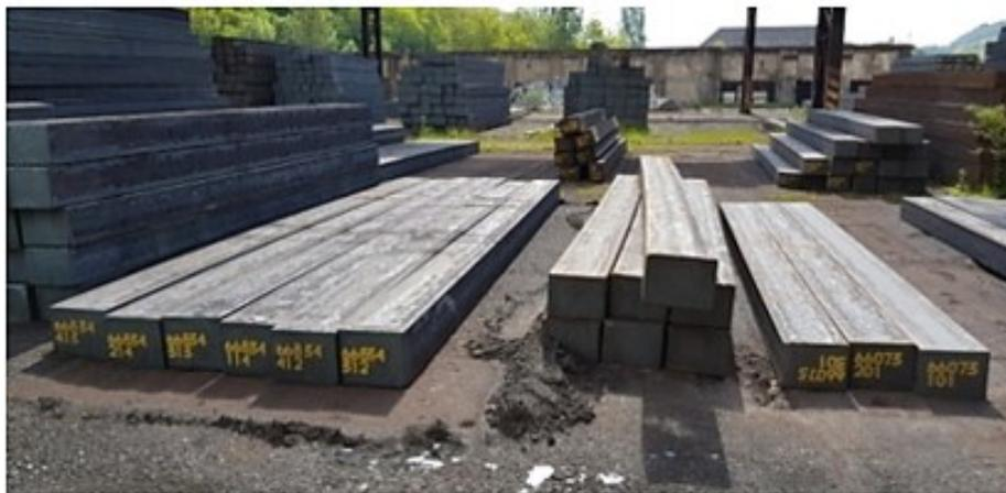
FIGURE 24 – Stockage de Bloom en attente de laminage.
