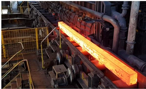
FIGURE 25 – Aperçu d'un bloom en sortie de four avant laminage.
