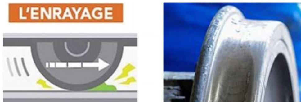
FIGURE I.40 – Conséquence d'un enrayage, un défaut de circularité des roues est généré. La roue devient plane localement.
