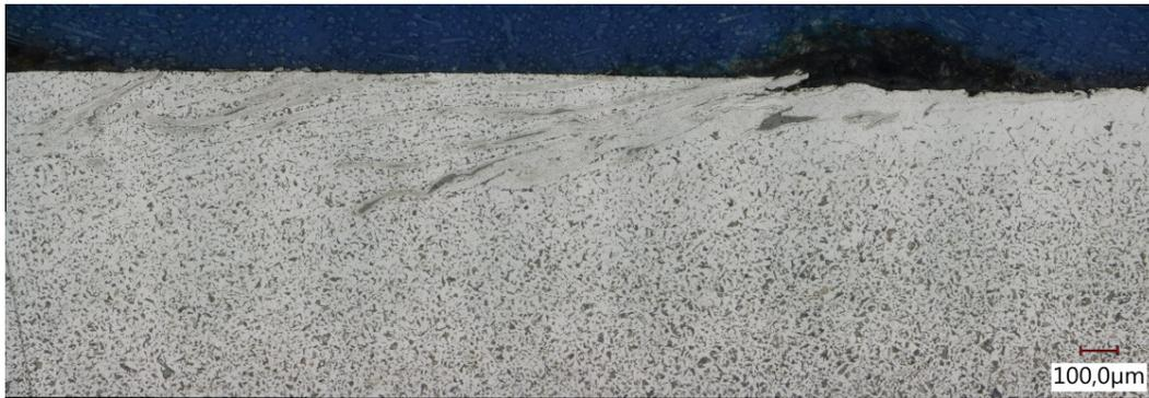
FIGURE I.7 – Microstructure d'un acier à roue brut de forge.
