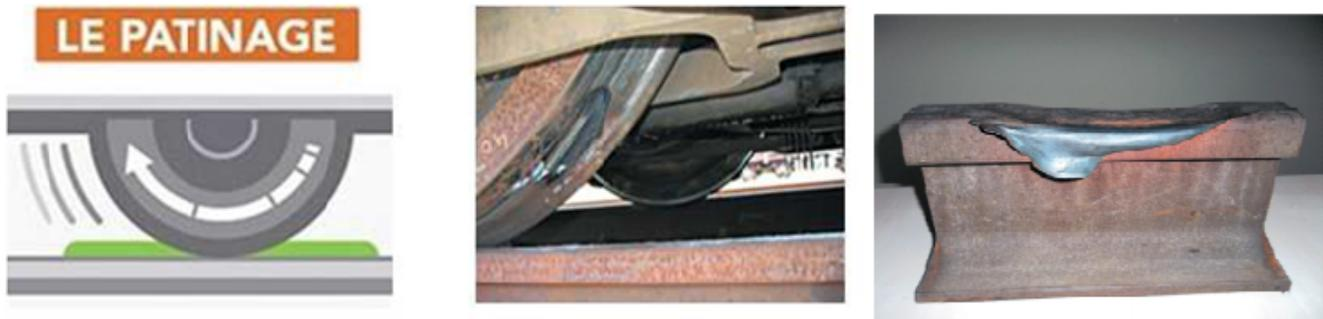
FIGURE I.39 – Conséquence d'un patinage sur roue et rail, les profils en surface des deux solides sont modifiés et endommagés.
