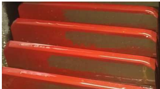
FIGURE 3.12 – Une mesure de la portée de denture. Couple mesuré 865Nm
