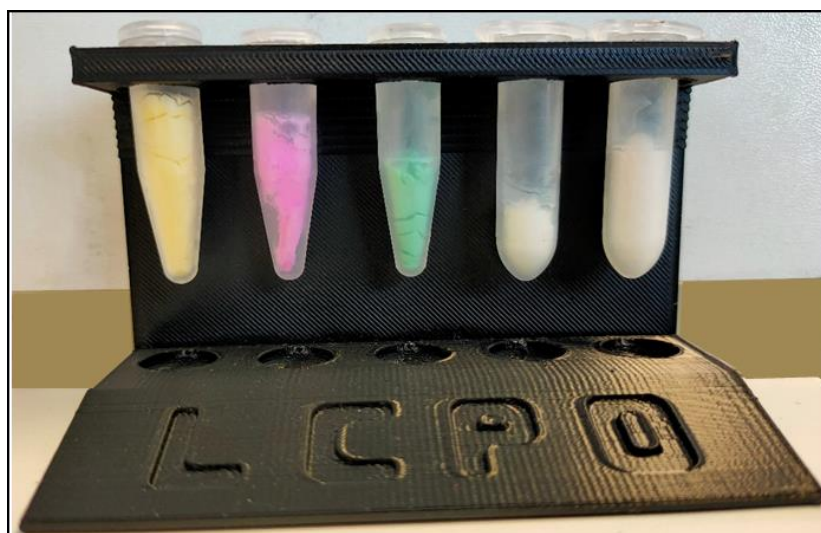
Figure IV-15 : Alcyne-ELPn60 et DBCO-ELPn80 fonctionnalisés avec les différents fluorophores après lyophilisation. De gauche à droite : fluorescéine, rhodamine, DY700, DY410, aucun (ELPn80 natif)
