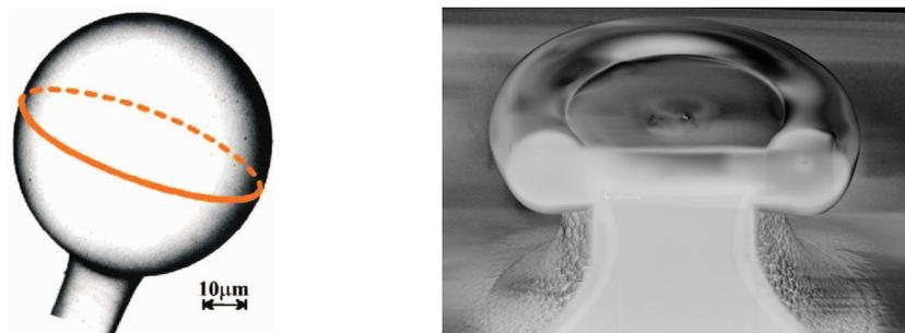
FIGURE 3.3 – À gauche : Image SEM d'une micro-sphère en silice de  $56\ \mu\text{m}$  de diamètre. Tirée de [159]. À droite : Image SEM d'une section au FIB d'un micro-tore de  $14\ \mu\text{m}$  de diamètre. Tirée de [161].
