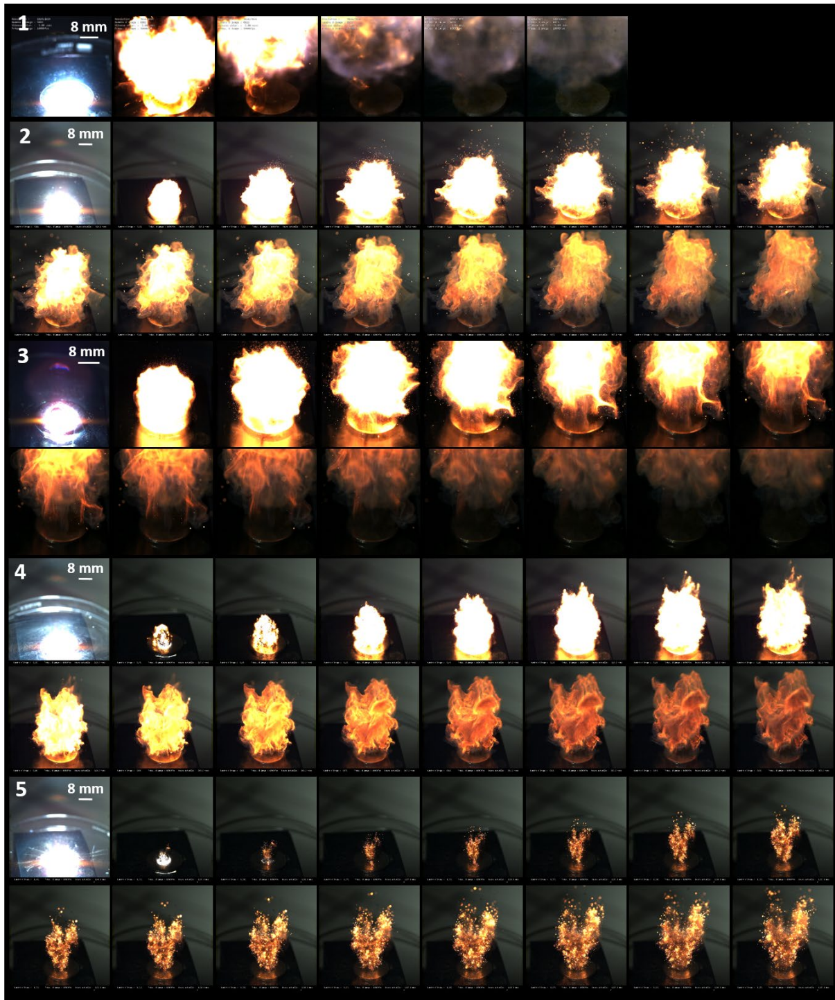
Figure 23 : Images de combustion, par allumage optique, des mélanges énergétiques ( t = 0 h) : (1) Al/SnO 2 , (2) Al/SnO 2 -PPy-D (PPy = 1,5 %), (3) Al/SnO 2 -PPy-C (PPy = 2,8 %), (4) Al/SnO 2 -PPy-B (PPy = 4,7 %) et (5) Al/SnO 2 -PPy-A (PPy = 8,4 %). L'intervalle de temps entre chaque image est de 1 ms.
