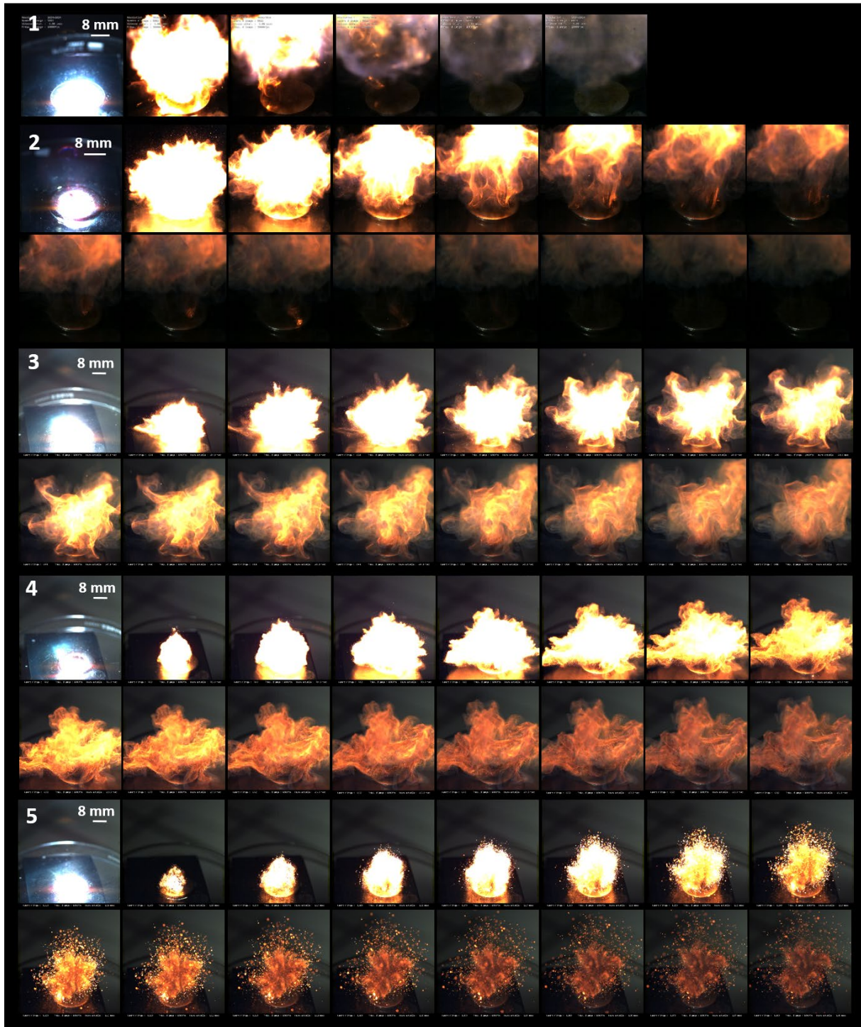
Figure 25 : Images de combustion, par allumage optique, des mélanges énergétiques ( t = 24 \text{ h} ) : (1) \text{Al/SnO}_2 , (2) \text{Al/SnO}_2\text{-PPy-}\delta ( \text{PPy} = 1,1 \% ), (3) \text{Al/SnO}_2\text{-PPy-}\gamma ( \text{PPy} = 3,4 \% ), (4) \text{Al/SnO}_2\text{-PPy-}\beta ( \text{PPy} = 5,6 \% ) et (5) \text{Al/SnO}_2\text{-PPy-}\alpha ( \text{PPy} = 9,6 \% ). L'intervalle de temps entre chaque image est de 1 ms.
