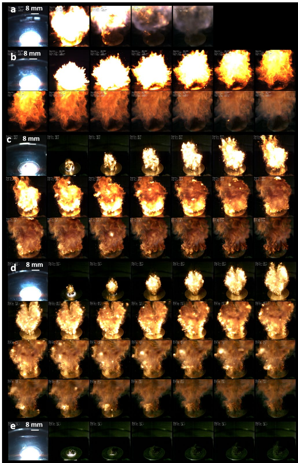
Figure 20 : Images de combustion par allumage optique des mélanges énergétiques : (a) Al/SnO_2 , (b) Al/SnO_2+PPy_5 , (c) Al/SnO_2+PPy_{10} , (d) Al/SnO_2+PPy_{12,2} et (e) Al/SnO_2+PPy_{15} . L'intervalle de temps entre chaque image est de 1 ms.
