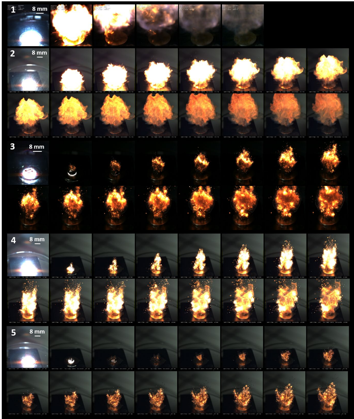
Figure 24 : Images de combustion, par allumage optique, des mélanges énergétiques ( t = 1 h) : (1) Al/SnO 2 , (2) Al/SnO 2 -PPy-d (PPy = 1,7 %), (3) Al/SnO 2 -PPy-c (PPy = 4,2 %), (4) Al/SnO 2 -PPy-b (PPy = 5,5 %) et (5) Al/SnO 2 -PPy-a (PPy = 8,9 %). L'intervalle de temps entre chaque image est de 1 ms.
