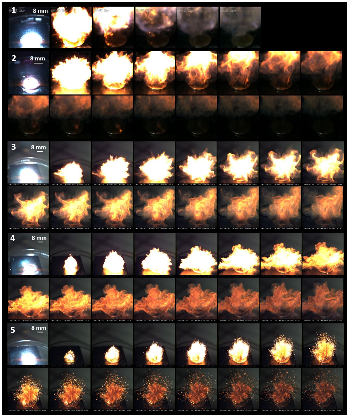
Figure 25 : Images de combustion, par allumage optique, des mélanges énergétiques ( t = 24 \text{ h} ) : (1) \text{Al}/\text{SnO}_2 , (2) \text{Al}/\text{SnO}_2\text{-PPy-}\delta ( \text{PPy} = 1,1 \% ), (3) \text{Al}/\text{SnO}_2\text{-PPy-}\gamma ( \text{PPy} = 3,4 \% ), (4) \text{Al}/\text{SnO}_2\text{-PPy-}\beta ( \text{PPy} = 5,6 \% ) et (5) \text{Al}/\text{SnO}_2\text{-PPy-}\alpha ( \text{PPy} = 9,6 \% ). L'intervalle de temps entre chaque image est de 1 ms.
