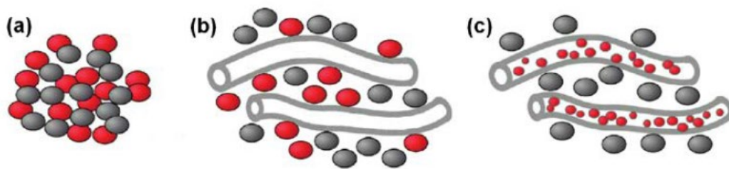
Figure 7 : Représentation schématique des différentes thermites examinées par l'équipe de Siegert : l'aluminium (sphères grises), l'oxyde de manganèse (sphères rouges) et les nanofibres de carbone. a) La thermite binaire, b) La thermite ternaire avec les fibres de carbone, c) La thermite ternaire avec les fibres de carbone contenant l'oxyde cristallisé à l'intérieur. Repris de [60].
