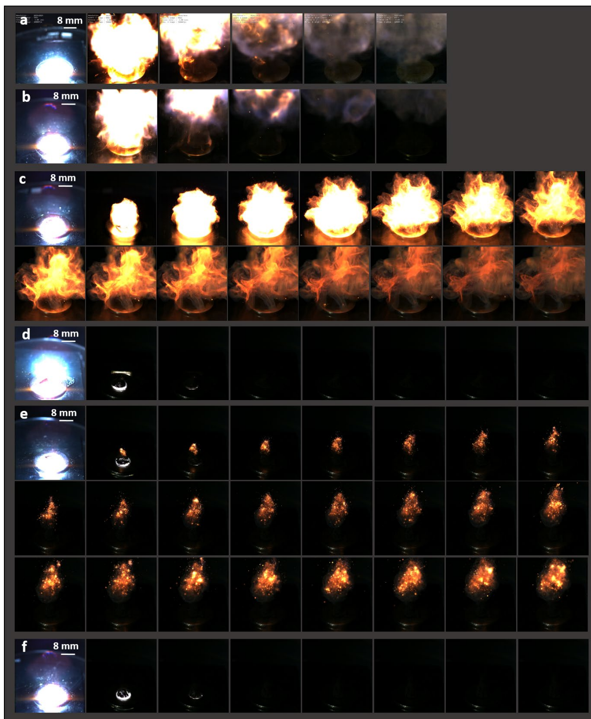
Figure 31 : Images de combustion par allumage optique des mélanges énergétiques par la synthèse one pot : (a) Al/SnO 2 , (b) Al-SnO 2 -PPy 1,2 , (c) Al-SnO 2 -PPy 2,3 , (d) Al-SnO 2 -PPy 3,2 , (e) Al-SnO 2 -PPy 5,7 et (f) Al-SnO 2 -PPy 8,0 . L'intervalle de temps entre chaque image est de 1 ms.
