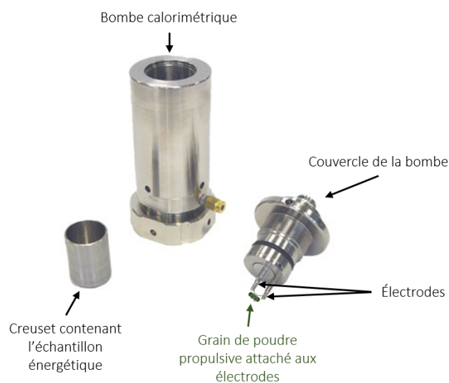
Figure 11 : Éléments de la bombe calorimétrique C62 de la marque IKA. Reprise de [19] avec des annotations personnelles du grain de poudre propulsive.
