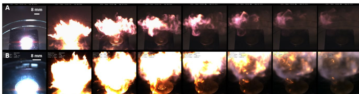
Figure 9 : Images de combustion par allumage optique des mélanges énergétiques (A) Al/SnO 2 SA et (B) Al/SnO 2 AA. L'intervalle de temps entre chaque image est de 0,5 ms.
