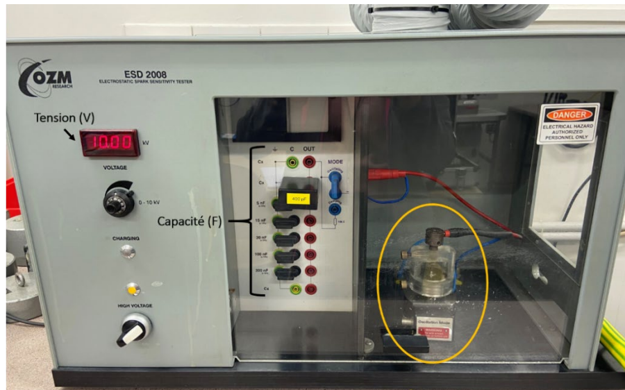
Figure 6 : Appareil d'OZM Research pour la détermination du seuil à la décharge électrostatique. La partie entourée en jaune correspond au dispositif où se situe la matière énergétique.
