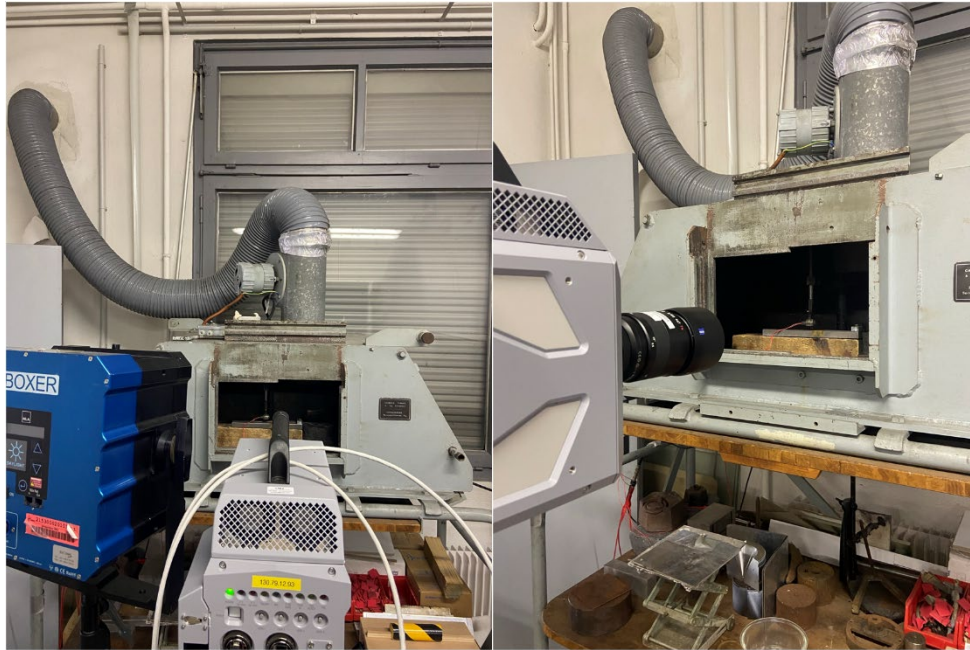
Figure 10 : Caisson de détonation timbré (pour résister à la détonation de 3 g d'équivalent TNT) avec la caméra rapide en place pour filmer un tir. Une vitre blindée est ajoutée avant le tir.
