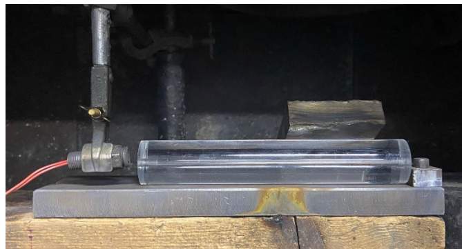
Figure 9 : Exemple de tube (vide) placé dans la chambre de combustion. L'allumeur est placé au dernier moment avant le tir.
