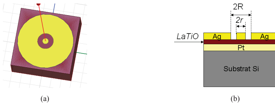
Figure V-16 – Structure de la capacité MIM a) Modèle de simulation b) vue en coupe
