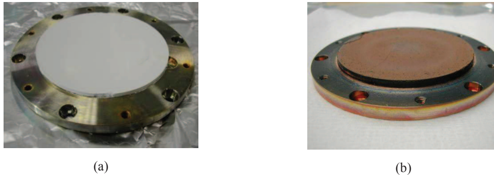
Figure III-6 - Photos des cibles utilisées pour le dépôt des couches minces La-Ti-O-N (a) oxyde La_2Ti_2O_7 (b) oxynitride LaTiO_2N
