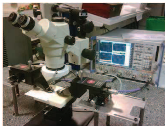
Figure III-28 - Station de mesure sous pointes, utilisée pour la caractérisation en hautes fréquences, installée au CEA-LETI à Grenoble
