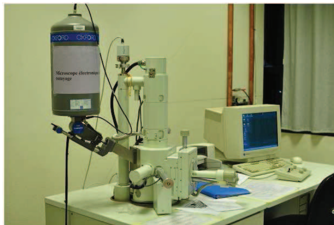
Figure III-8 - Photo du Microscope électronique à balayage (MEB) JEOL JSM 5600 installé au département SGM de l'IUT de Saint Brieuc
