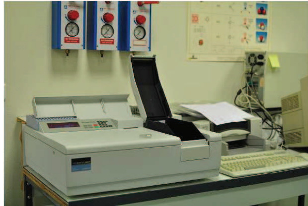
Figure III-9 – Photo du spectromètre UV-Visible Perkin-Elmer Lambda 20 installé au département SGM de l'IUT de Saint Brieuc
