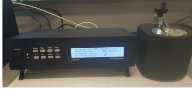
Figure 30. Photographie du piezomètre PM200
