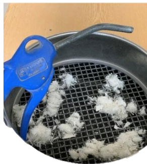
Figure 12. Séparation des fibres en laboratoire
