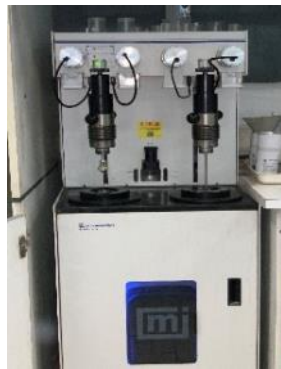
Figure 36. Prosimètre à mercure/ Autopore V- version 9605
