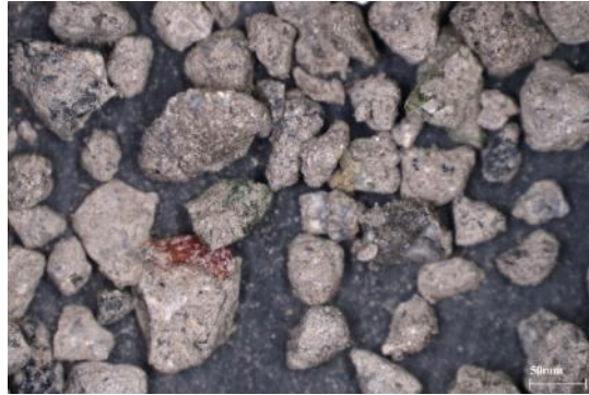
Figure 30. Observation de la forme des grains de mâchefers avec le microscope optique
