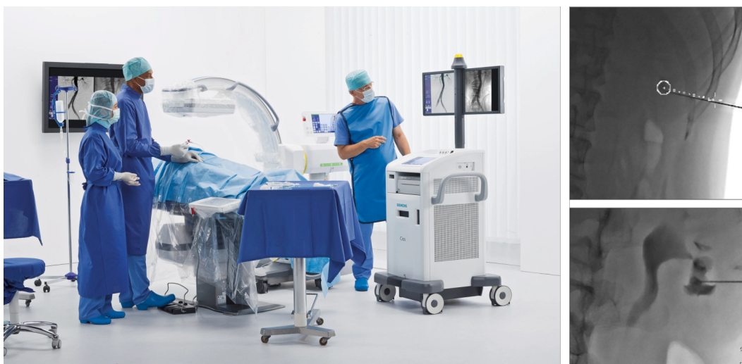
FIGURE 1.7 – Imageur C-ARM avec des exemples d’images. L’image de gauche provient du site https://www.itnonline.com/ , c’est un C-ARM robotisé. Les images fluoroscopiques proviennent de (Jiao et al., 2018). Elles ont été prises durant une néphrolithotripsie (élimination de calcul rénal) percutanée. On remarque la tache sombre qui représente le calcul. L’orientation de l’image inférieure fait apparaître le pelvis.
