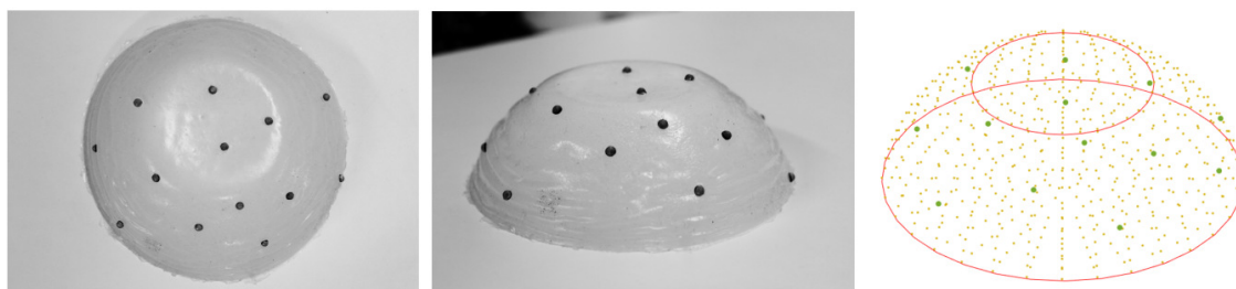
FIGURE 6.6 – Fantôme en silicone. À gauche, deux photos du fantôme avec les marqueurs de surface. À droite, la surface reconstruite avec les marqueurs de surface.
