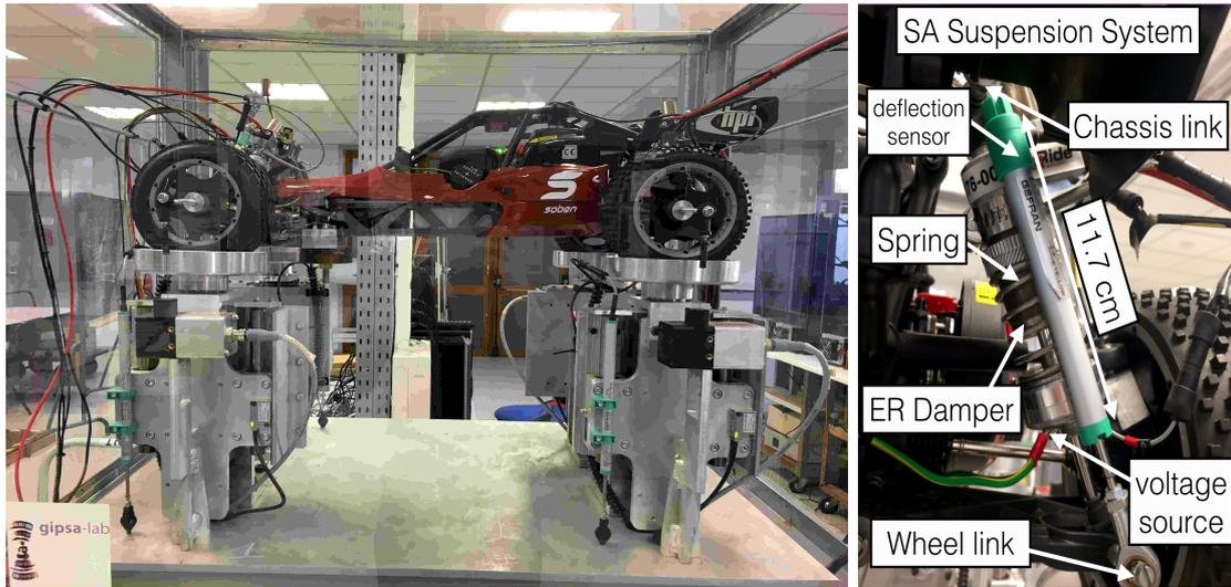
Figure 5: Le banc d'essai expérimental INOVE au GIPSA-lab.
