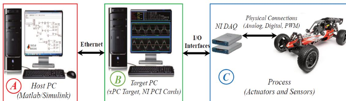
Figure 4: Schéma de la plateforme expérimentale INOVE [Tudón-Martínez et al. 2015]
