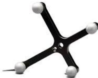
Figure 3.2 – Marqueurs passifs utilisés avec le localisateur optique.
