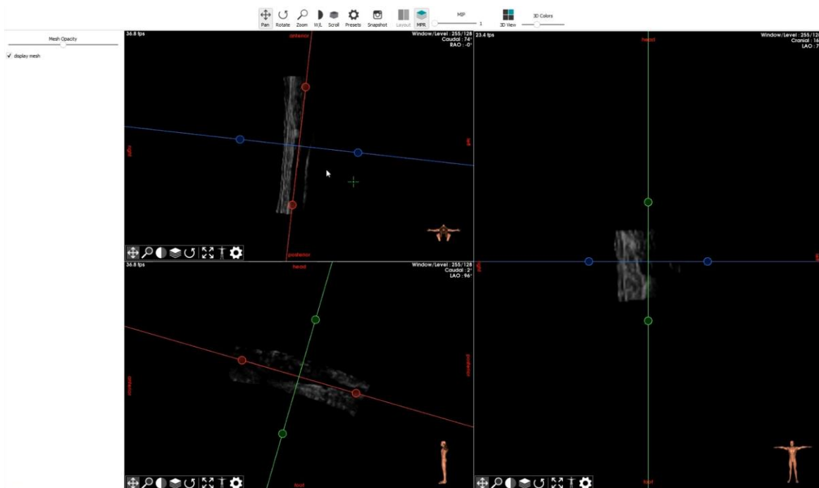
Figure 6.4 – Capture d’écran d’EndoSize® avec le volume échographique reconstruit. L’outil de reconstruction multiplanaire permet de définir un plan à partir duquel seront générées des coupes pour la visualisation.
