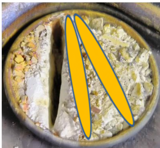
Figure 81 : Photographie du creuset de ZnS après un dépôt avec la trace du balayage du faisceau d'électrons et représentation schématique des autres traces réalisables.
