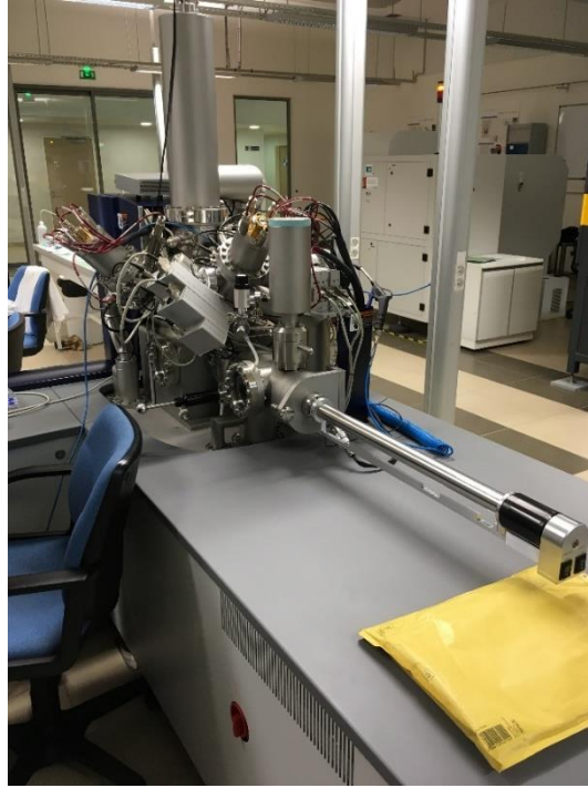
Figure 86 : Photo du TOF-SIMS utilisé
