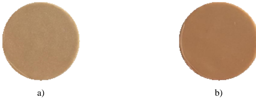
Figure 48 : a) Pastille dense frittée réalisée par coulage en bande (composée de 2 disques de 100 µm empilés) ; b) Pastille dense frittée réalisée par coulage en bande (composée de 4 disques de 100 µm empilés)
