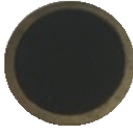
Figure 43 : Pastille dense de GDC10 avec un squelette poreux GDC10 ainsi que la couche de collectage LNF sérigraphiée
