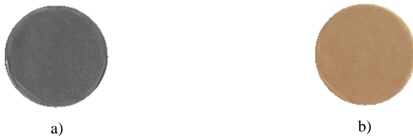
Figure 64 : Photo d'un sandwich poreux/dense/poreux contenant 50 % de fibres de carbone : a) avant frittage et b) après frittage
