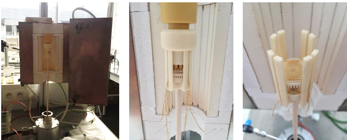
Figure 21 : Photos du montage utilisé pour réaliser les mesures d'impédance
