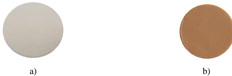
Figure 36 : a) Photo d'une cellule crue obtenue après pressage uni-axial ; b) cellule dense obtenue après frittage
