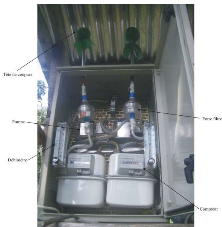
Figure 2.8 : Dispositif pour la collecte d'aérosols atmosphériques avec discrimination en taille et en composition chimique (cette étude).
