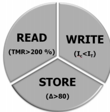
FIGURE 1.21 – [81] Trois propriétés doivent être satisfaites simultanément pour un bon fonctionnement de la STT-MRAM. Dans cet exemple, il est nécessaire d'avoir une TMR > 200\% pour une lecture fiable, un courant de retournement ( I_c ) inférieur à celui fourni par un petit transistor ( I_T ) pour une petite taille de cellule MRAM et un facteur de stabilité thermique \Delta > 80 pour atteindre un objectif de conservation stable des données.
