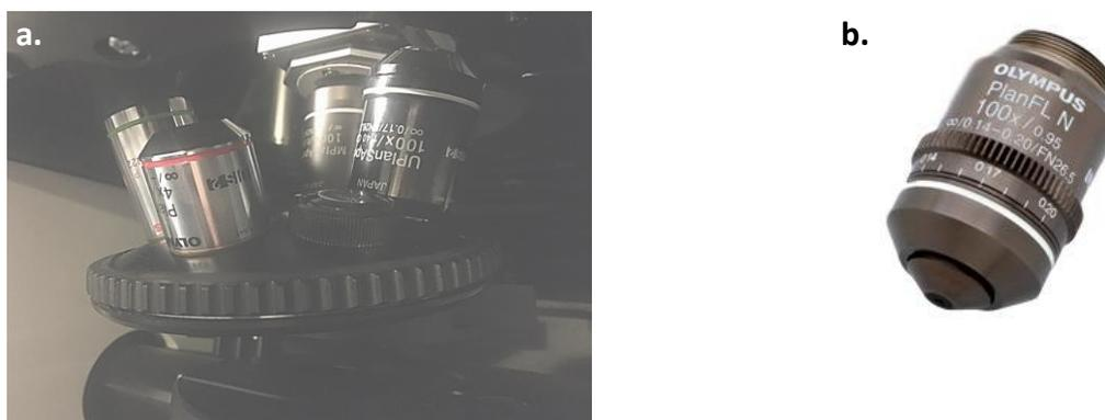
Figure 3.9: **a.** Tourelle à objectifs munie des objectifs Olympus. **De gauche à droite:** MPlan20x (**vert**), PlanN4x (**rouge**), MPlanApo100x (**blanc**) et UPlanSApo100x (**blanc**). **b.** Objectif à bague de correction.
