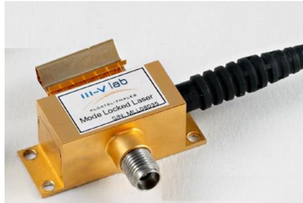
Figure 9.7 Boîtier du Module QD-MLLD fabriqué par le III-V LAB
