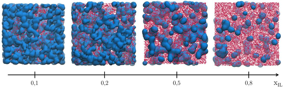
FIGURE 4.4 – Représentation des domaines d’acétonitrile (en bleu) pour différents mélanges BMIMTFSI/ACN allant de  $x_{LI} = 0,1$  à  $x_{LI} = 0,8$ . Les points rouges correspondent aux atomes du liquide ionique BMIMTFSI.
