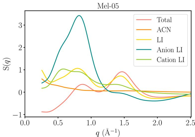
FIGURE 4.6 – Facteurs de structure total et partiels de l'acétonitrile, du liquide ionique, de l'anion TFSI<sup>-</sup> et du cation BMIM<sup>+</sup> pour le mélange Mel-05.
