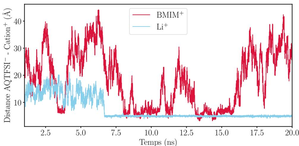
FIGURE 5.2 – Distances AQTFSI<sup>-</sup> - BMIM<sup>+</sup> et AQTFSI<sup>-</sup> - Li<sup>+</sup> au cours du temps, entre 1 et 20 ns. Les distances ont été calculées entre les centres de masse des deux molécules.
