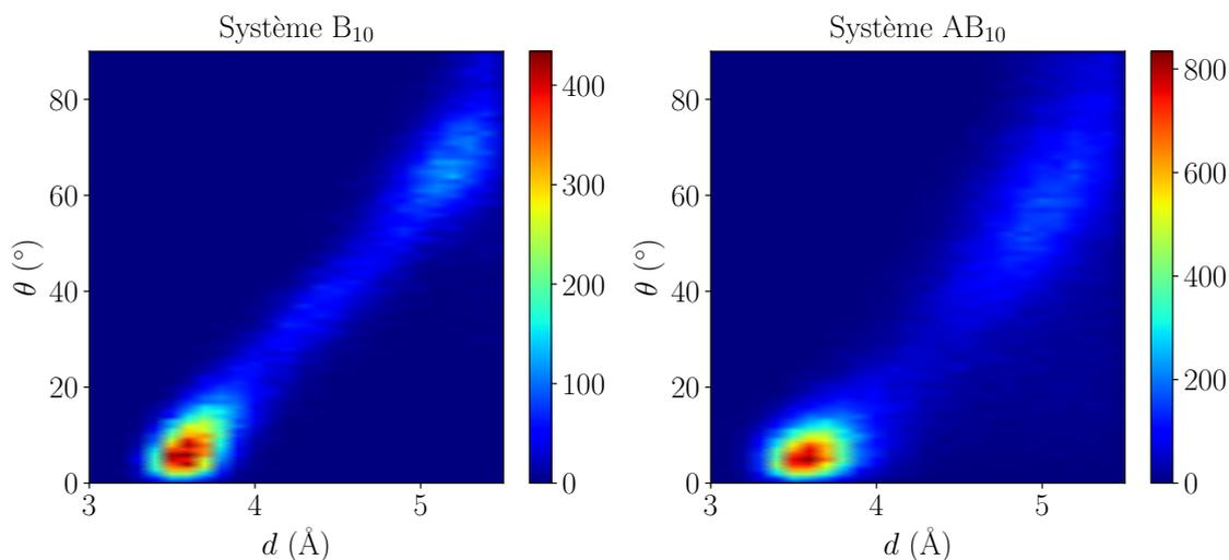
FIGURE 5.13 – Carte de stacking montrant l'angle  $\theta$  en fonction de la distance  $d$  entre chaque anthraquinone. L'échelle de couleur de la carte correspond à l'occurrence des couples d'ions AQTFSI<sup>-</sup>.
