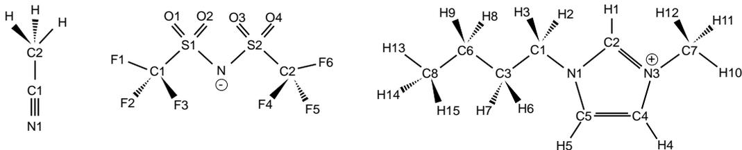
FIGURE 4.1 – Représentation des molécules présentes dans les mélanges avec les noms des atomes qui seront utilisés lors de l'étude. De gauche à droite : ACN, TFSI<sup>-</sup> et BMIM<sup>+</sup>.
