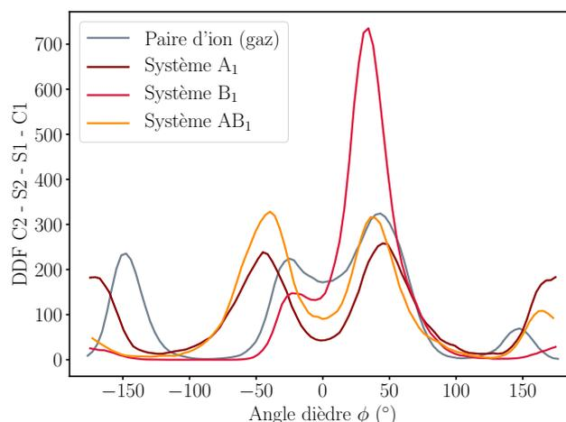
FIGURE 5.9 – Distribution du pseudo angle dièdre (DDF) C2 - S2 - S1- C1 pour les systèmes A<sub>1</sub>, B<sub>1</sub> et AB<sub>1</sub> ainsi que pour la paire d'ion AQTFSI<sup>-</sup>-BMIM<sup>+</sup> en phase gaz.
