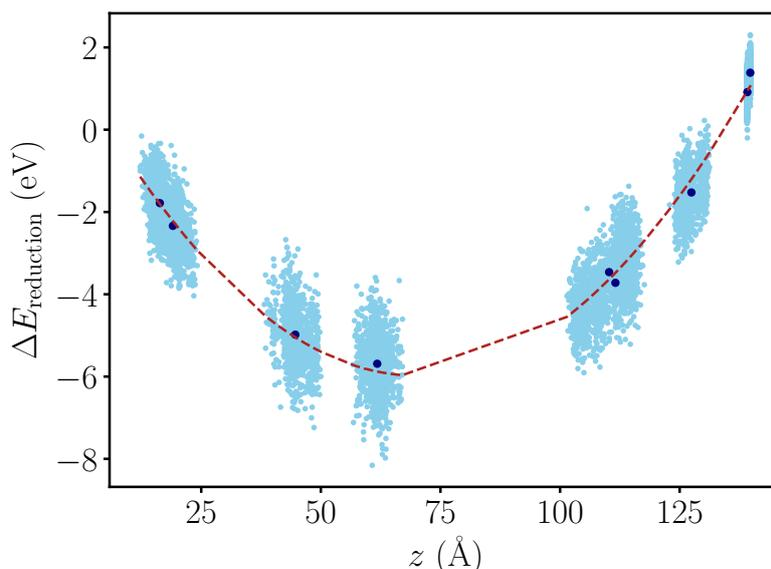
FIGURE 6.17 – *Vertical Energy Gaps* ( $\Delta E$ ) obtenus pour les réactions  $\text{AQTFSI}^- + 2e^- \rightarrow \text{AQTFSI}^{3-}$  pour chaque configuration et pour chacun des ions à différentes positions  $z$  dans la boîte de simulation avec une différence de potentiel appliquée de 0 V (représentés en bleu clair). Les points bleus foncés représentent les moyennes pour chaque ion et la courbe rouge correspond à l’ajustement d’une équation polynomiale d’ordre 2.
