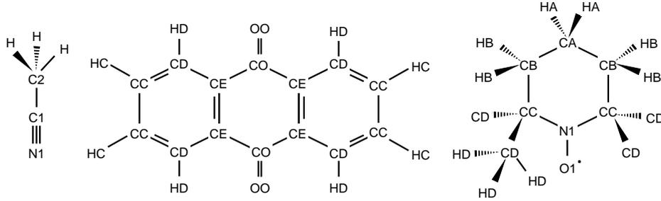
FIGURE 3.2 – Structure schématique de l’acétonitrile (ACN), de l’antraquinone (AQ) et du 2,2,6,6-tetra-méthylpiperidiny-1-oxyl (TEMPO), avec les labels des types d’atomes. Il est à noter que pour TEMPO, les atomes d’hydrogène sur les carbones CD ne sont montrés explicitement que pour un seul groupement méthyle pour plus de clarté.
