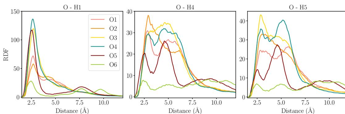
FIGURE 5.4 – Fonctions de distribution radiale entre les oxygènes de AQTFSI<sup>-</sup> et les hydrogènes H1, H4 et H5 du cation BMIM<sup>+</sup>.
