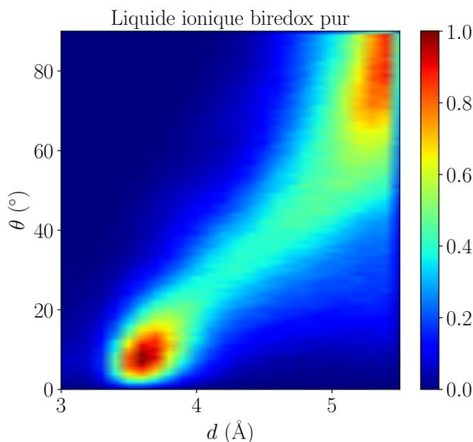
FIGURE 6.7 – Carte de stacking pour le liquide ionique biredox pur montrant l'angle  $\theta$  en fonction de la distance  $d$  entre chaque groupement anthraquinone. L'échelle de couleur de la carte correspond à la probabilité de trouver un couple d'ions AQTF $\text{SI}^-$  à une certaine distance et avec un certain angle.
