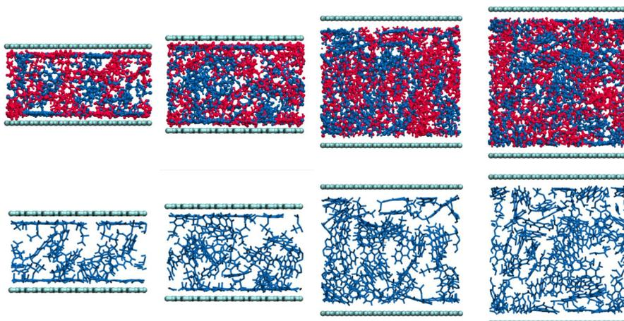
FIGURE 6.11 – Panneau supérieur : Boîtes de simulation des systèmes P16, P20, P30 et P35 contenant les cations TEMPOmIM<sup>+</sup> (en rouge) et les anions AQTF SI<sup>-</sup> (en bleu). Panneau inférieur : Mêmes boîtes de simulation mais pour lesquelles les cations ont été enlevés pour ne laisser que les anions AQTF SI<sup>-</sup>.
