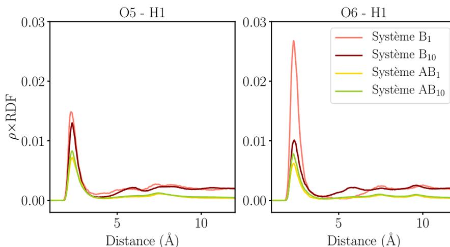
FIGURE 5.10 – RDFs multipliées par la densité numérique de l'atome observé ( $\rho$ ) entre les oxygènes O5 (à gauche) et O6 (à droite) d'AQTFSI<sup>-</sup> et l'hydrogène H1 de BMIM<sup>+</sup> pour les systèmes B<sub>1</sub>, B<sub>10</sub>, AB<sub>1</sub> et AB<sub>10</sub>.
