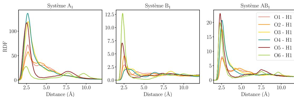
FIGURE 5.8 – RDFs entre les six oxygènes d'AQTFSI<sup>-</sup> et l'hydrogène H1 de BMIM<sup>+</sup> pour les systèmes A<sub>1</sub>, B<sub>1</sub> et AB<sub>1</sub>.
