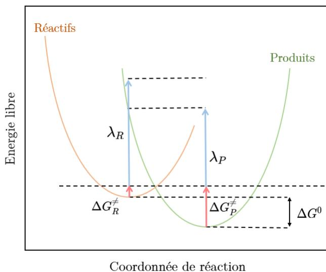
FIGURE 2.3 – Représentation schématique du profil d'énergie libre de la réaction en fonction de la coordonnée de réaction.
