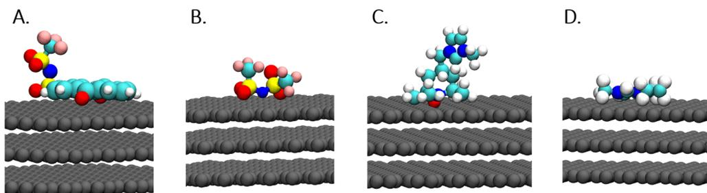
FIGURE 6.16 – Représentation des ions  $\text{AQTF SI}^-$  (A),  $\text{TF SI}^-$  (B),  $\text{TEMPOmIM}^+$  (C) et  $\text{BMIM}^+$  (D) adsorbés à l'interface avec l'électrode. La fonctionnalisation a pour effet de modifier l'orientation de la partie liquide ionique.
