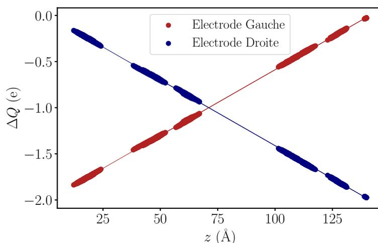
FIGURE 6.18 – Valeur de la charge sur les électrodes gauche et droite en fonction de la distance  $z$  de l'espèce par rapport à l'électrode lors du passage de l'ion  $\text{AQTF SI}^{3-}$  à l'ion  $\text{AQTF SI}^-$ .
