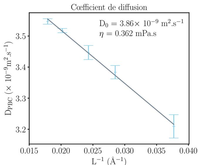
FIGURE 3.5 – Coefficient de diffusion de l'acétonitrile  $D_{\text{PBC}}$  pour cinq boîtes de simulations, en fonction de l'inverse de la taille de la boîte  $L$ . Les barres d'erreurs correspondent à l'intervalle de confiance à 95 %.[94]
