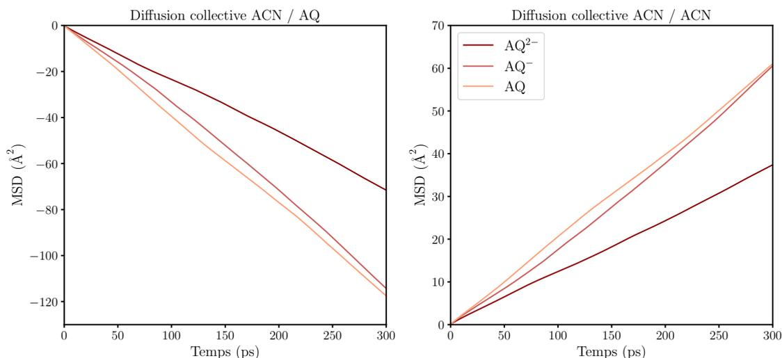
FIGURE 3.10 – Déplacements carrés moyens collectifs acétonitrile/anthraquinone (à gauche) et acétonitrile/acétonitrile (à droite) pour les trois états d'oxydation de l'anthraquinone (respectivement AQ,  $AQ^{\bullet-}$  et  $AQ^{2-}$ ).
