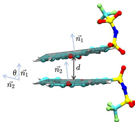
FIGURE 5.11 – Schéma explicatif des paramètres permettant de quantifier le stacking.  $d$  représente la distance minimale entre les centres des cycles des anthraquinones. L'angle  $\theta$  est calculé à partir des vecteurs normaux aux plans,  $\vec{n}_1$  et  $\vec{n}_2$ .
