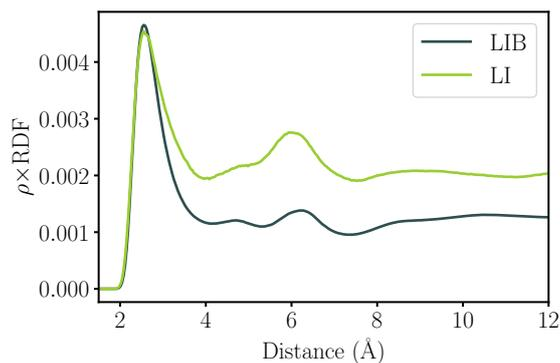
FIGURE 6.2 – RDFs, corrigées par la densité numérique  $\rho$  de l'atome observé, O1,4-H1 et O1,4-H8 pour le liquide ionique (LI) et le liquide ionique biredox (LIB). Il est à noter que les noms des atomes sont différents pour BMIM $^+$  et TEMPOmIM $^+$ , mais les hydrogènes H1 et H8 correspondent au même atome.
