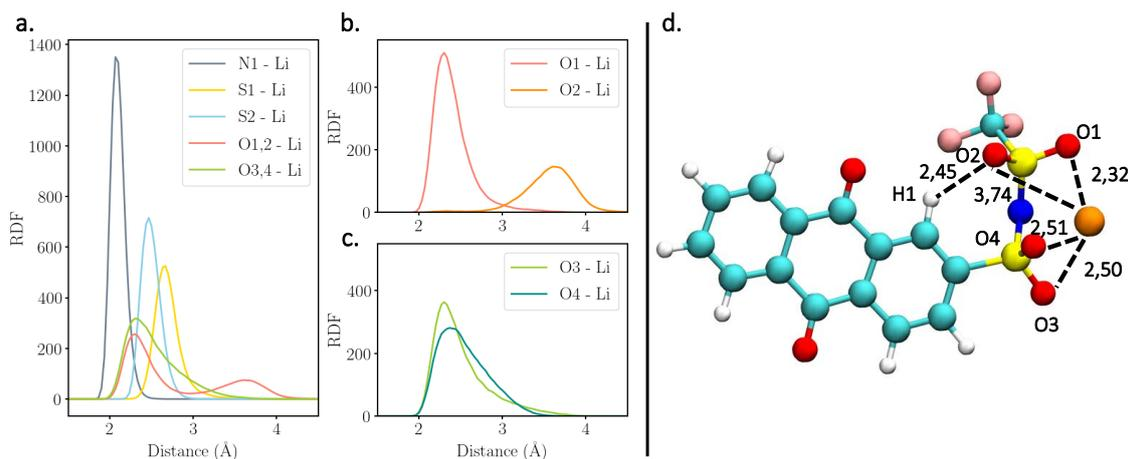
FIGURE 5.3 – (a) Fonctions de distribution radiale (RDFs) N1-Li, O1,2-Li, O3,4-Li, S1-Li et S2-Li, entre le groupement TFSI de AQTFSI<sup>-</sup> et le contre-ion Li<sup>+</sup>. (b) Fonctions de distribution radiale O1-Li et O2-Li. (c) Fonctions de distribution radiale O3-Li et O4-Li. (d) Représentation de l'interaction entre le lithium (en orange) et les différents atomes du groupement TFSI, notamment les oxygènes (en rouge).
