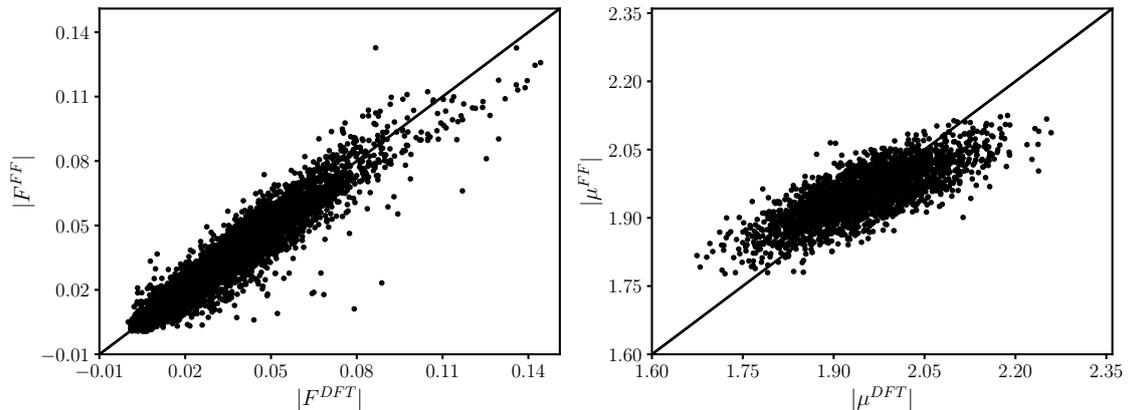
FIGURE 3.1 – Accord entre les forces  $F^{FF}$  (respectivement les dipoles  $\mu^{FF}$ ) et les forces  $F^{DFT}$  (respectivement les dipoles  $\mu^{DFT}$ ) calculés par le champ de force pour l'ajustement des paramètres de l'acétonitrile.
