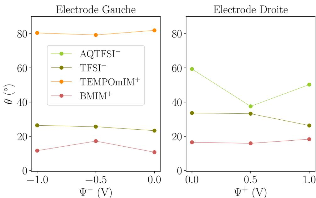
FIGURE 6.15 – Valeurs des angles entre les ions AQTFSl<sup>-</sup>, TFSl<sup>-</sup>, TEMPOmIM<sup>+</sup> et BMIM<sup>+</sup> et les électrodes de gauche et de droite pour les différents potentiels appliqués aux électrodes.
