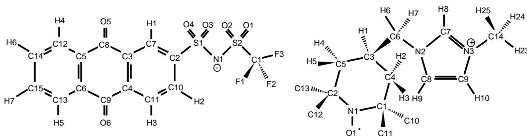
FIGURE 6.1 – Structure schématique du liquide ionique biredox avec l'anion  $\text{AQTFSI}^-$  (à gauche) et le cation  $\text{TEMPOmIM}^+$  (à droite), avec les noms des atomes. Il est à noter que pour  $\text{TEMPOmIM}^+$ , les atomes d'hydrogène sur les carbones C10-13 ne sont pas montrés explicitement pour plus de clarté.
