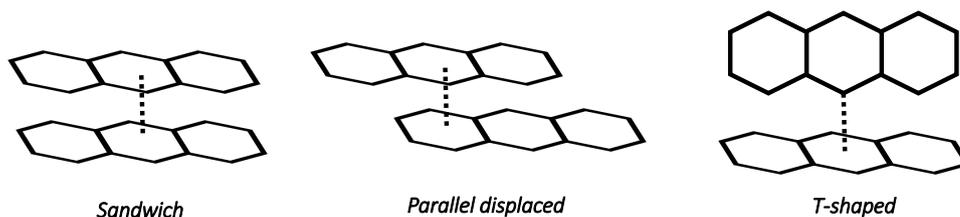
FIGURE 5.12 – Schéma montrant les différents types de stacking pouvant être observé.
