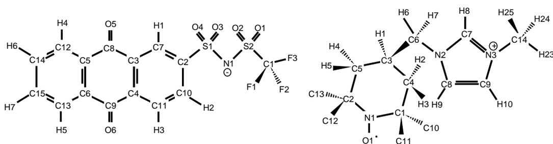
FIGURE 3.11 – Structure schématique du liquide ionique biredox AQTFISI<sup>-</sup> (à gauche) et TEMPOmIM<sup>+</sup> (à droite), avec les labels des types d'atomes. Il est à noter que pour TEMPOmIM<sup>+</sup>, les atomes d'hydrogène sur les carbones C10-13 ne sont pas montrés explicitement pour plus de clarté.
