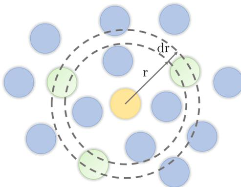
FIGURE 2.4 – Schéma du calcul de la fonction de distribution radiale. En jaune la particule centrale  $i$ , et en vert les particules  $j$  comprises entre deux sphères de rayons  $r$  et  $r + dr$  centrées en  $i$ .
