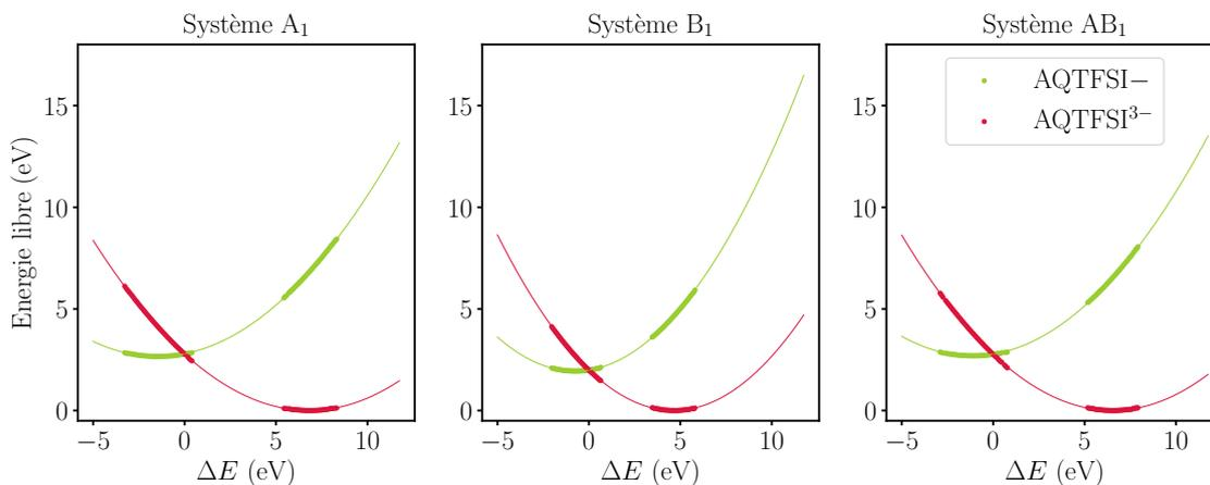
FIGURE 5.14 – Tracé des courbes de Marcus représentant l'énergie libre de la réaction d'oxydoréduction en fonction du *Vertical energy gap*  $\Delta E$  pour les systèmes A<sub>1</sub>, B<sub>1</sub> et AB<sub>1</sub>.
