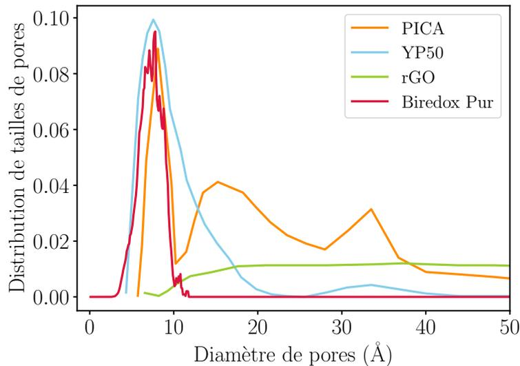
FIGURE 6.9 – Comparaison des distributions de tailles de pores pour les anions du liquide ionique biredox (rouge), et les carbones poreux PICA (orange), YP50 (bleu) et rGO (vert). Les valeurs selon  $y$  sont arbitraires puisque la distribution de tailles de pores calculée correspond à une occurrence et n'a donc pas d'unité.
