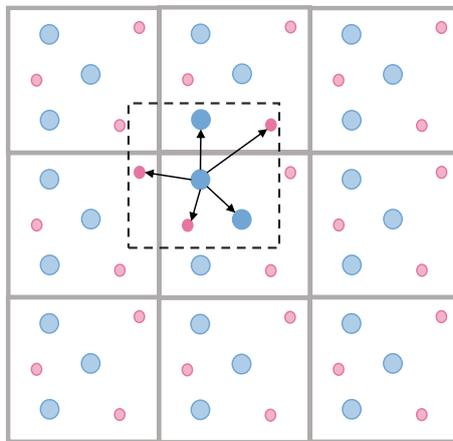
FIGURE 2.1 – Représentation schématique des conditions aux limites périodiques.
