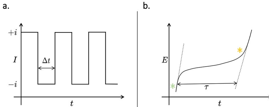
FIGURE 1.2 – Schéma de la variation du courant en fonction du temps lors d’une expérience de cyclage galvanostatique (a). Schéma de la réponse  $E - t$  obtenue lors d’une expérience de cyclage galvanostatique (b).
