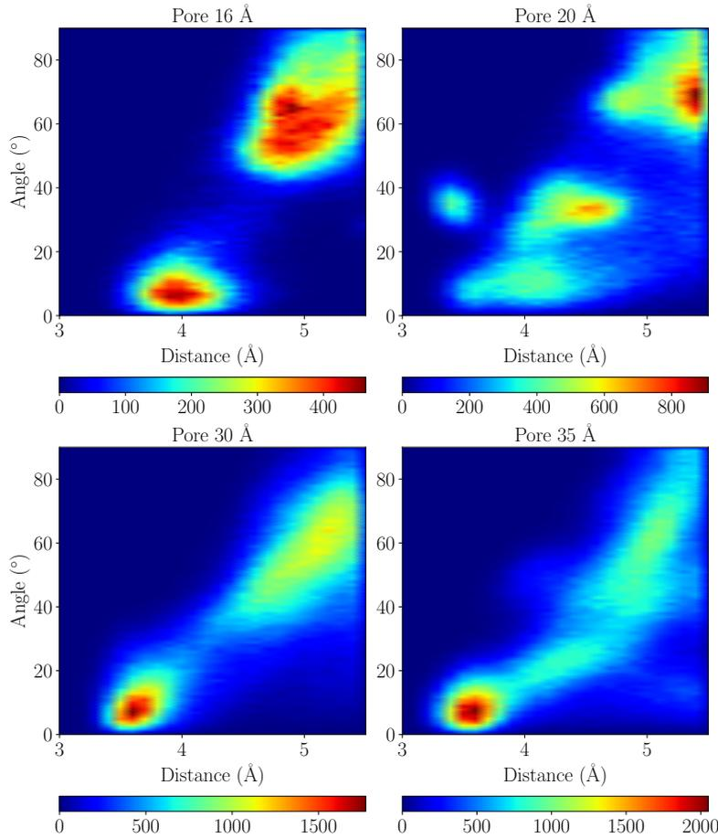
FIGURE 6.10 – Cartes de stacking montrant l’angle  $\theta$  en fonction de la distance  $d$  entre chaque anthraquinone pour les systèmes P16, P20, P30 et P35. L’échelle de couleur de la carte correspond à l’occurrence de tous les couples d’ions AQTFSI<sup>-</sup>.
