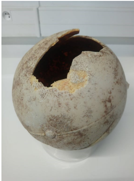
Figure IV.2.1. Bouée plastique de PE photo-oxydée en condition environnementale.
