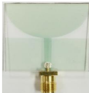
Figure 1-34 : Antenne ultra large bande en multicouche IZTO/Ag/IZTO [90]
