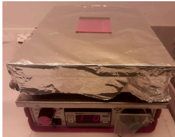
Figure 3-23 : Recuit de la résine sur plaque chauffante à 100°C après son enduction
