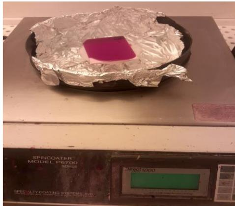
Figure 3-20 : Spin-coater pour enduction de la résine
