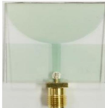
Figure 1-34 : Antenne ultra large bande en multicouche IZTO/Ag/IZTO [90]
