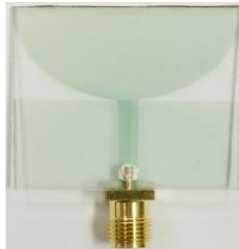
Figure 1-34 : Antenne ultra large bande en multicouche IZTO/Ag/IZTO [90]
