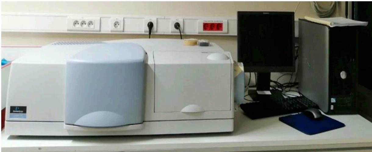
Figure 4-11 : Spectrophotomètre Perkin Elmer lambda 1050 [165]
