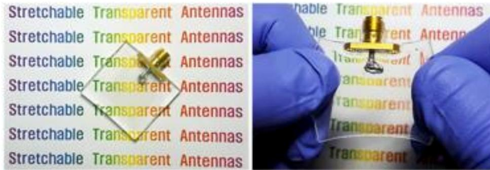
Figure 1-41 : Antenne transparente flexible en AgNWs
