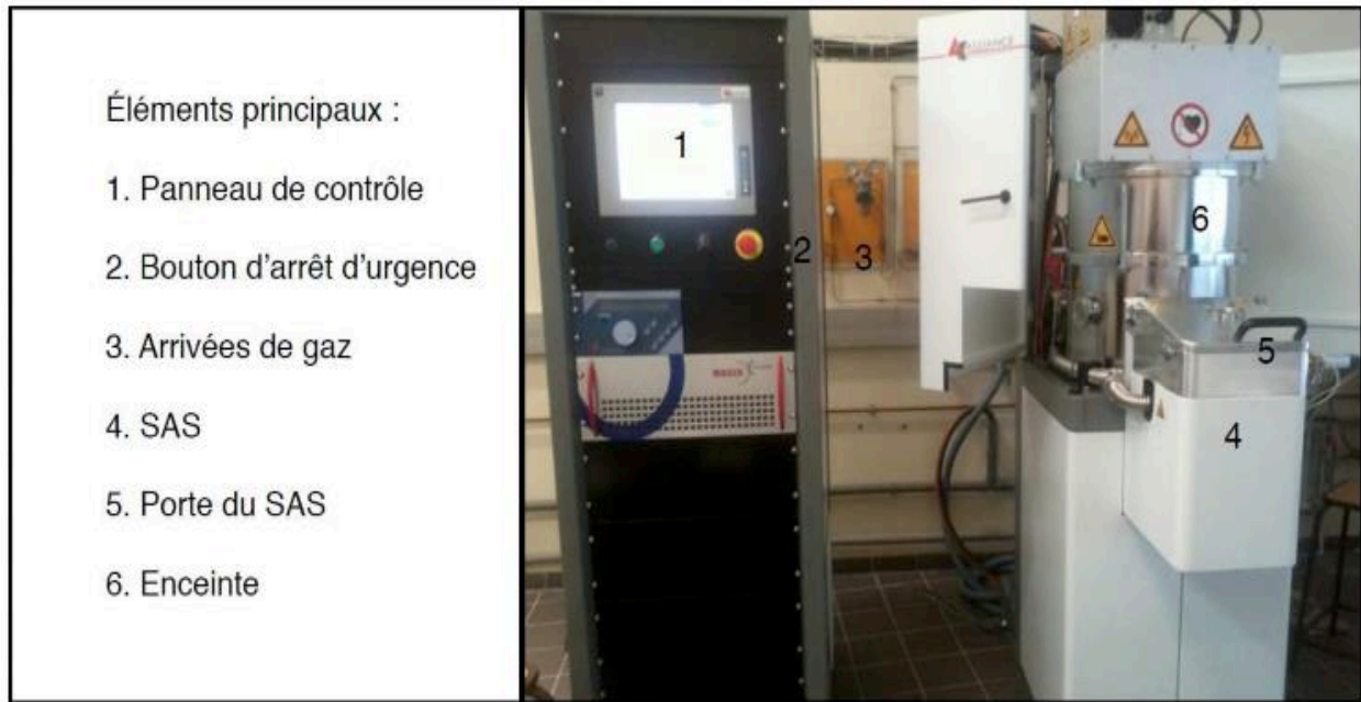
Figure 3-13 : Bâti de pulvérisation cathodique magnétron AC450 de la société Alliance Concept
