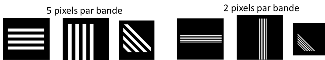
Figure 5.40 – Mire avec nombre variable de cycle, de fréquence contrôlée, avec trois orientations.
