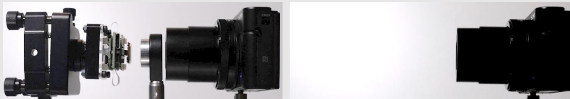
Figure 5.41 – Gauche : caméra de mesure avec l'EVF. Droite : caméra de mesure (CDM) seule.
