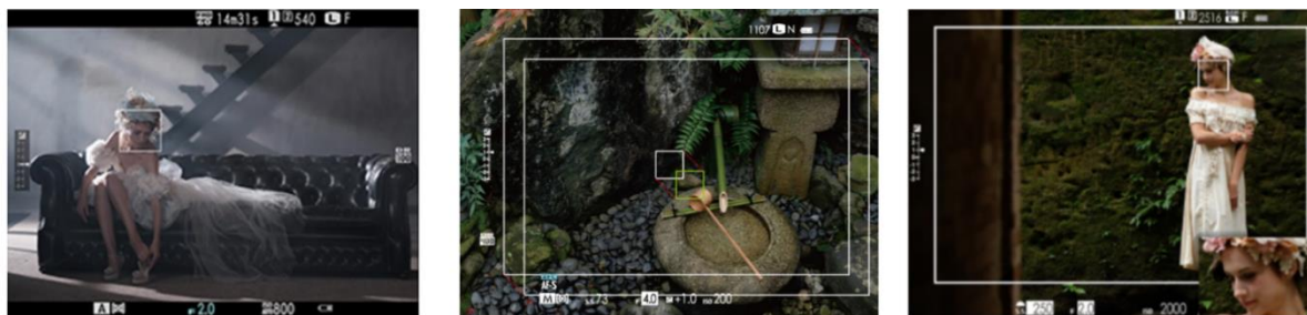
Figure 5.4 – Image de Fujifilm montrant les trois façons d'utiliser le viseur du X-pro. Gauche : mode EVF. Centre : mode viseur direct avec correction de parallaxe. Droite : mode viseur direct avec agrandissement de la zone de mise au point en bas à droite.
