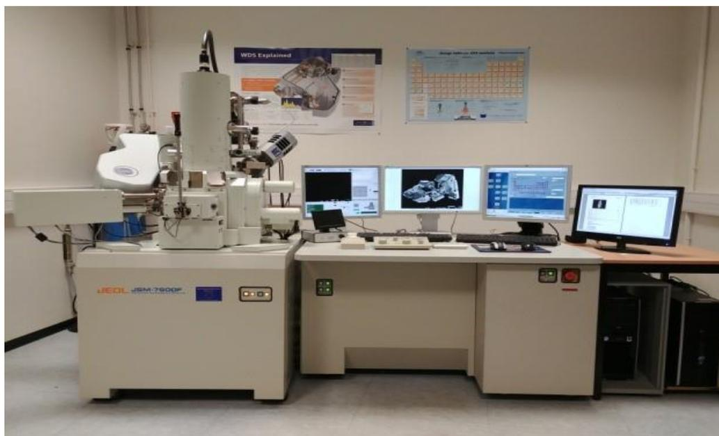
**Figure II.10.** Microscope électronique à balayage JOEL JDM 7100F.
