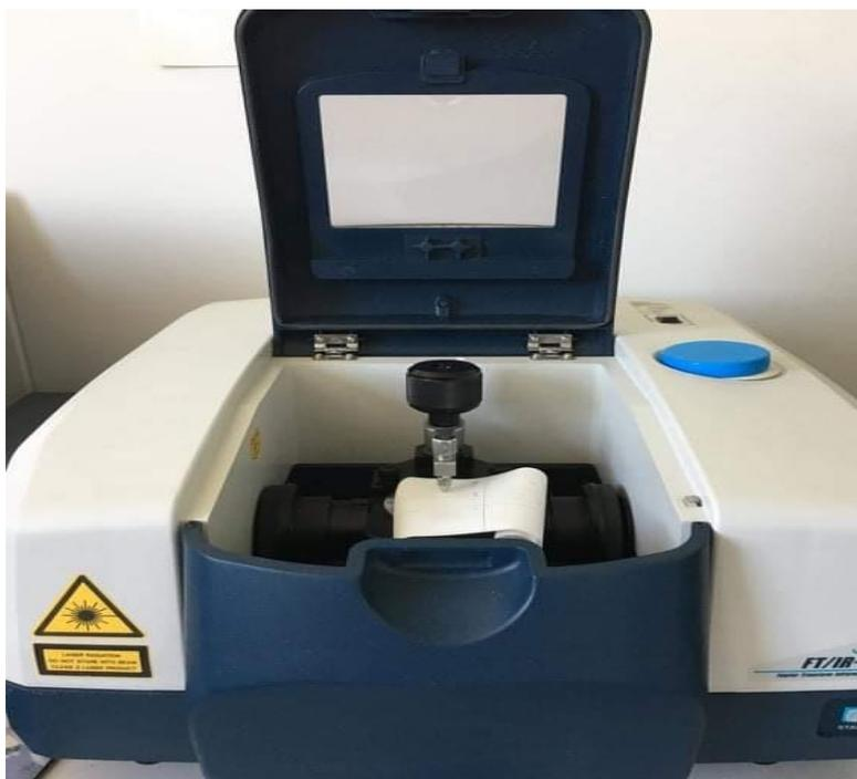
**Figure II.5.** Spectromètre FTIR-ATR.
