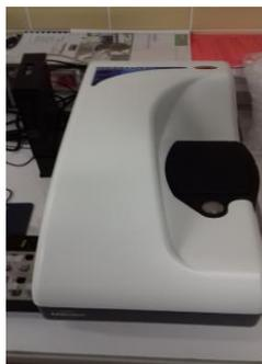
*Figure 22 : photographie de l'appareil Zeta Sizer Malvern*
