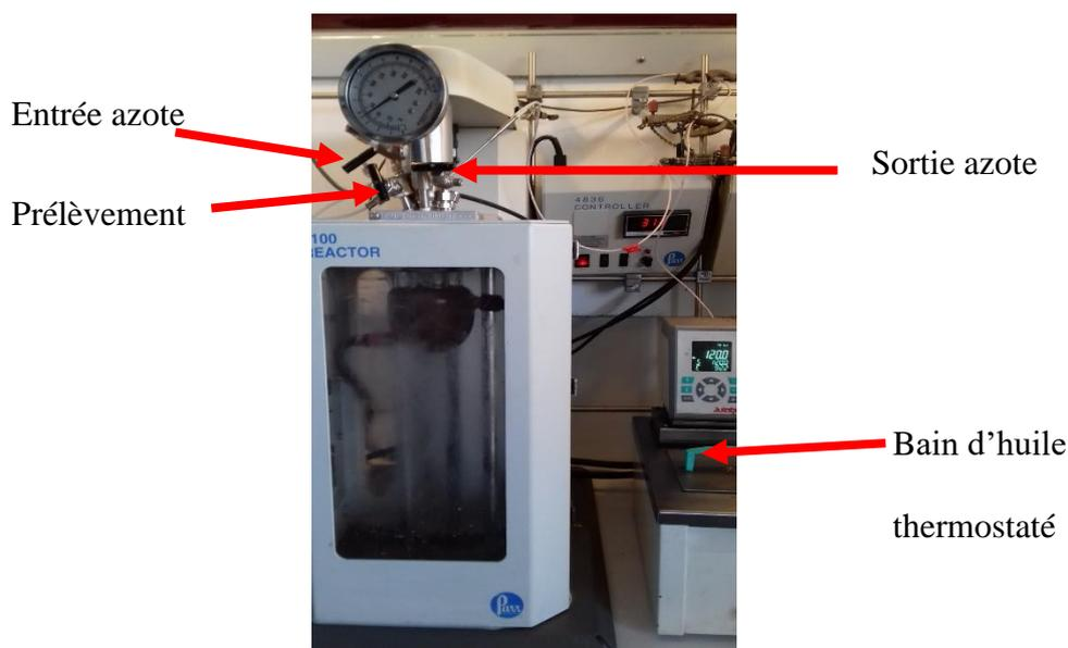
*Figure 18 : Photographie du réacteur sous pression utilisé*
