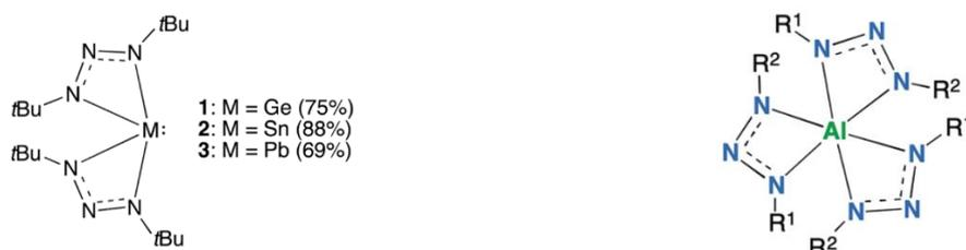
Figure 1-49: Complexes homoleptiques prometteurs des groupes 13, 14 et 15 pour des dépôts par CVD ( $R_1, R_2 = iPr, sBu, tBu$ ) développés par le groupe de Pedersen et al.<sup>140,141</sup>
