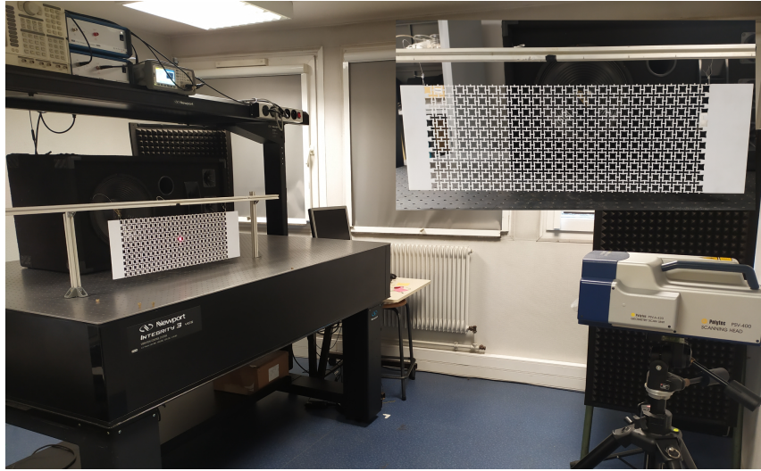
FIGURE 3.18 – Photo du dispositif expérimental d’identification des modes de flexion des plaques suspendues avec une excitation aérienne.
