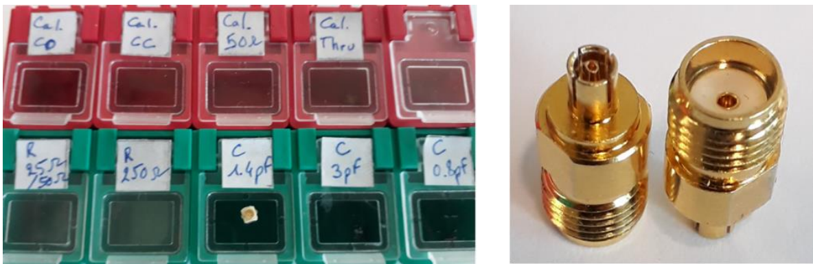
Figure 108: Composants CMS du kit de calibrage et composants caractérisés pour déduire les paramètres L_0 et C_0 du calibrage (à gauche), adaptateur CMA-UFL (à droite).
