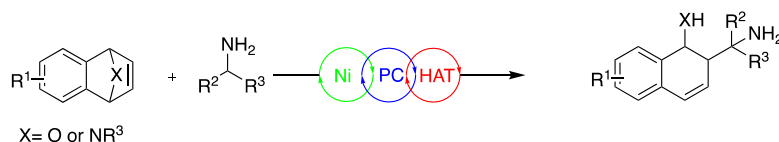
Schéma 146 : Proposition d'une réaction d'ouverture d'oxa- et d'azabenzonorbornadiènes par des radicaux en \alpha d'amines primaires.
