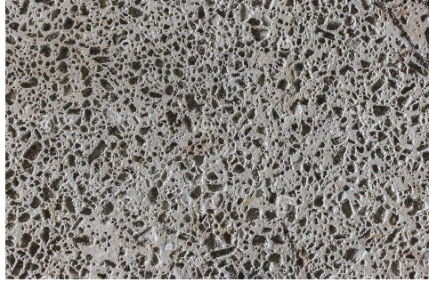
FIGURE 1.2 – Section droite d'un milieu poreux statistiquement isotrope. Les zones noires représentent l'espace des pores.
