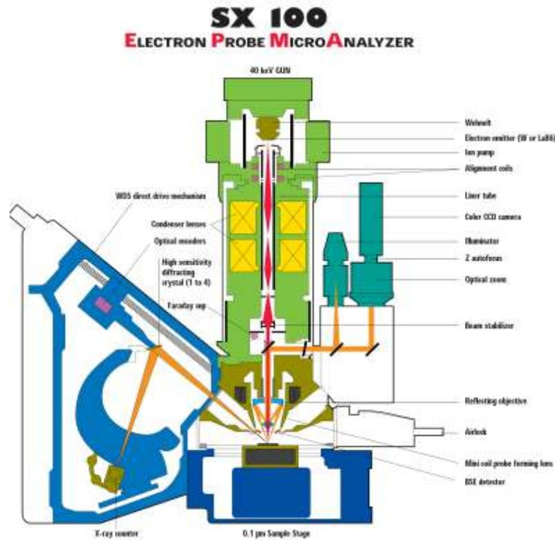
Figure 25 : Principe de fonctionnement de la microsonde électronique (Source : Cameca)
