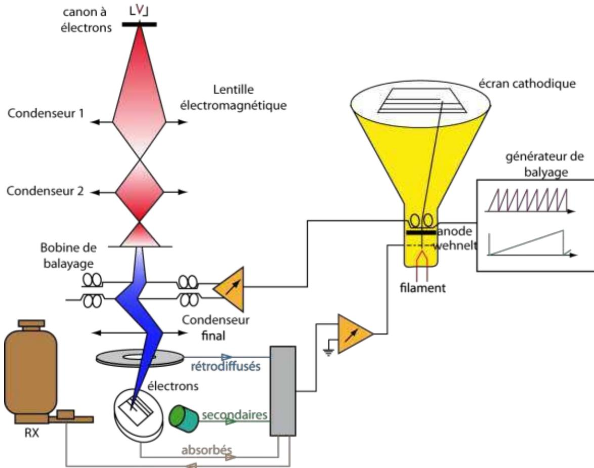
Figure 24 : Principe de fonctionnement du MEB
