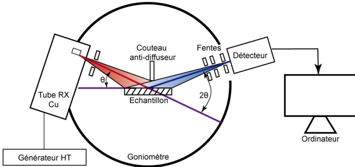
Figure 22 : Schéma de principe de la DRX
