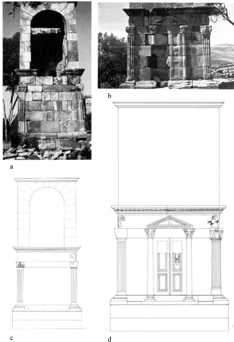
Fig. 211. Monument de Sidi Ali Bel-Khacem : a. photographie de la façade méridionale (Ferchiou, 1986, fig. 13, p. 697) ; b. photographie du niveau inférieur de la façade orientale (Ferchiou, 1986, fig. 16, p. 698) ; c. relevé de l'élévation de la façade méridionale (Ferchiou, 1986, fig. 30, p. 704) ; d. relevé de l'élévation de la façade orientale (Ferchiou, 1986, fig. 31, p. 705).
