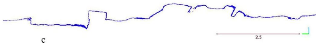
Fig. 12. Réalisation de coupes dans les nuages de points extraits des photogrammétries avec le logiciel CloudCompare ; a. position des coupes sur la vue zénithale du nuage de points ; b. vue inclinée des coupes (sans le nuage de points) c. projection orthogonale d'une des coupes.
