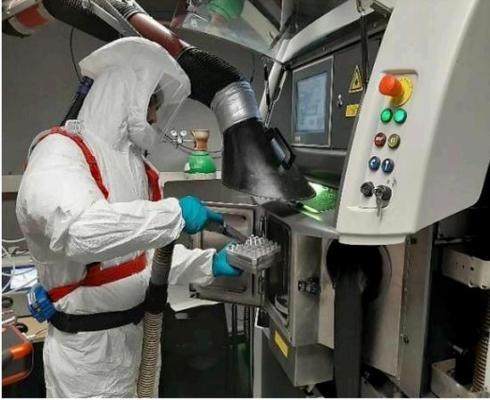
*Figure 29 : Aspiration et nettoyage de la pièce fabriquée en 3D*
