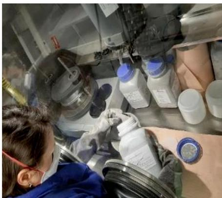
**Figure 26 :** *Opération du tamisage de la poudre métallique*
