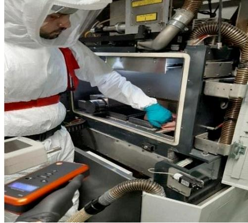
*Figure 30 : Nettoyage du plateau de fabrication*
