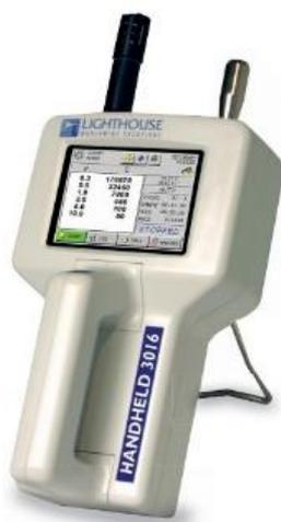
**Figure 7 :** Compteur de particules Lighthouse HH3016
