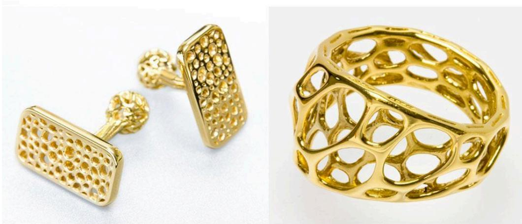
*Figure 10 : Impression en 3D de bijoux en or (source : A3DM additive manufacturing)*
