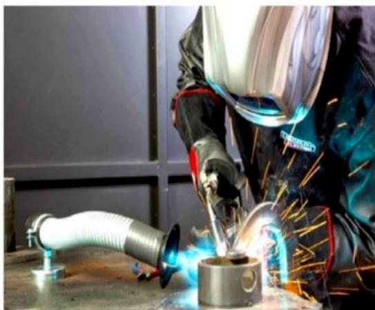
*Figure 23 : Soudeur utilisant une ventilation aspirante locale (OSHA, 2005)*
