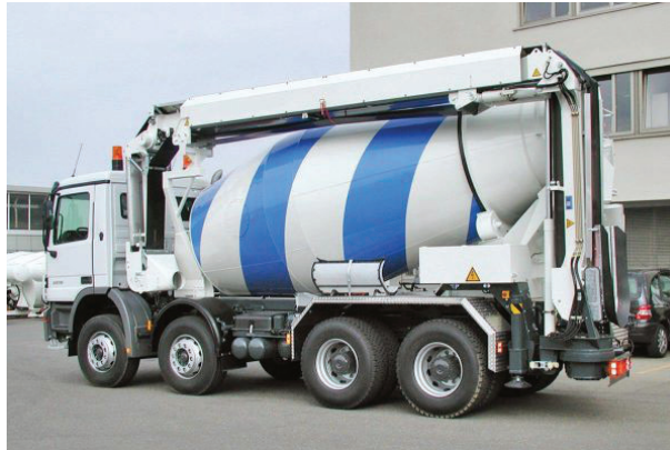
FIGURE 1.5 – Camion toupie équipé d'un tapis
