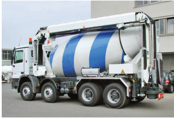
FIGURE 1.5 – Camion toupie équipé d'un tapis
