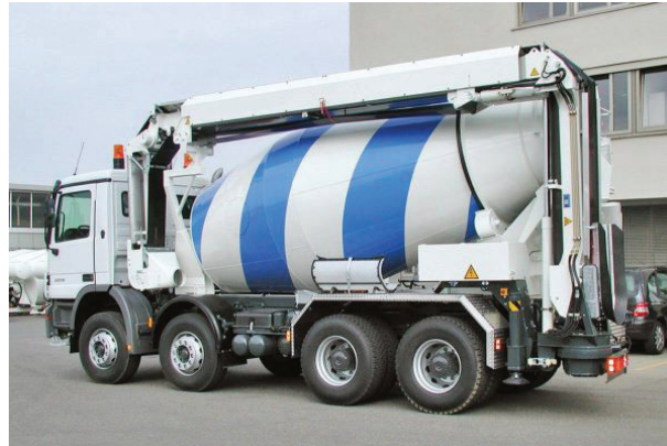
FIGURE 1.5 – Camion toupie équipé d'un tapis
