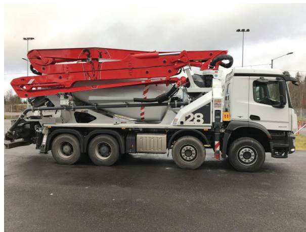
FIGURE 1.3 – Camion toupie équipé d'une pompe (pumi)
