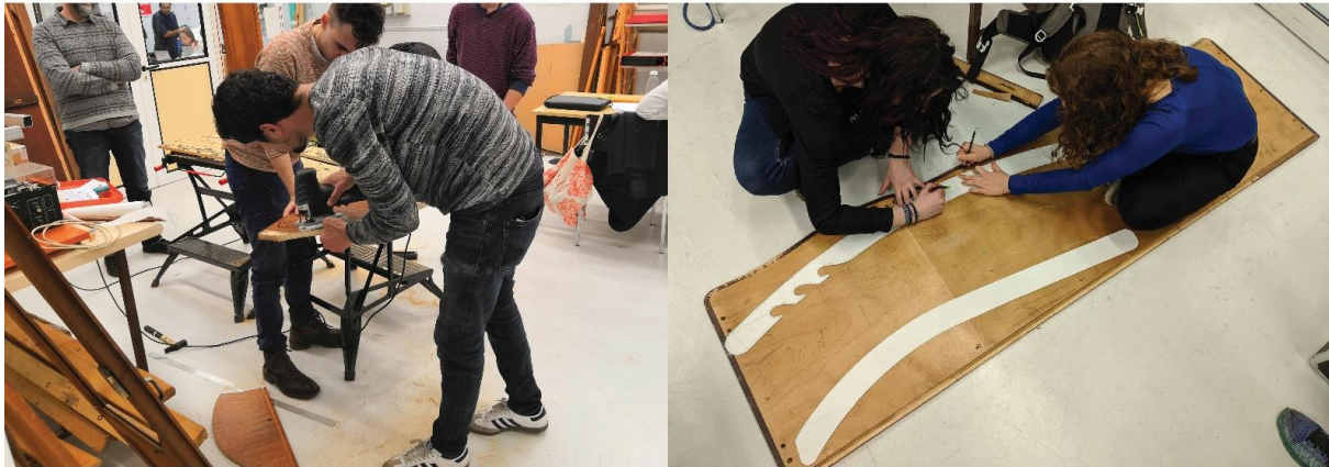
Figure 26 : Gauche : découpe des pièces de structure de la « chilienne N°104 ». Droite : traçage avant découpe du balancier et des pièces de structure de la « Rocking Chill ».
