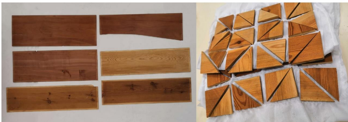
Figure 25 : essais de textilisation du bois. « Chilienne N°104 ». Gauche : planches d'origine. Droite : triangles découpés, agrafés sur un textile.
