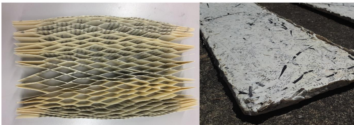
Figure 8 : gauche : prototype de matériau alvéolaire en bandes de pages. HERBERT Clara. Droite : Prototype de panneau aggloméré en bandelettes de pages de livre. LAMARQUE Nicolas.
