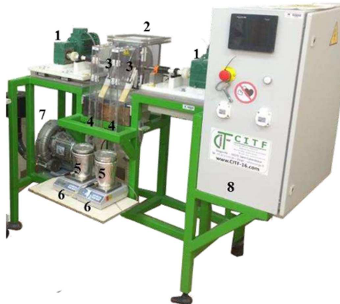
Figure I.18. Schéma du descriptif (a) et photographie (b) du séparateur tribo-aéroélectrostatique à deux disques métalliques. 1 : Moteurs électriques ; 2 : Chambre de séparation ; 3 : Electrodes-disques métalliques tournants ; 4 : Collecteurs ; 5 : Cages de Faraday ; 6 : Balances électroniques ; 7 : Soufflante ; 8 : Armoire électrique [122].
