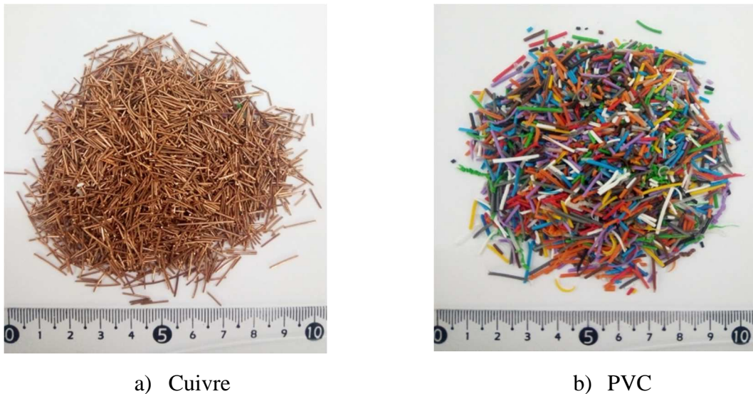
Figure IV.14. Photographies des échantillons granulaires de métal et de polymère utilisés dans le cadre de l'étude du séparateur à tambour.
