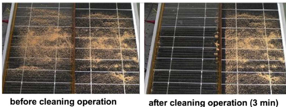
Figure I.14. Démonstration de l'efficacité du système de nettoyage électrostatique sur un grand panneau solaire [104].
