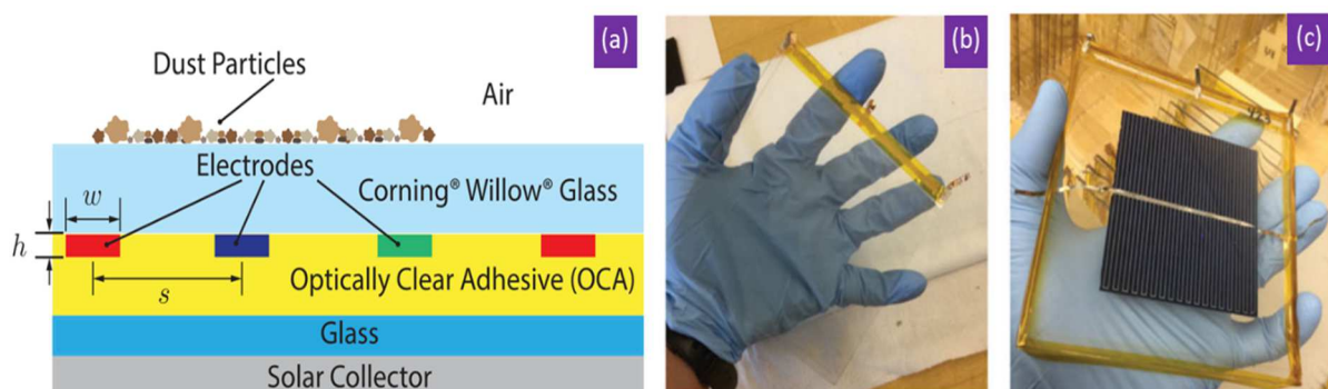
Figure I.15. (a) Vue de coupe de la configuration de l'EDS avec deux couches diélectriques transparentes. (b) Photographie d'un film EDS avant la couverture sur un module PV. (c) Film EDS collé sur un panneau solaire [113].
