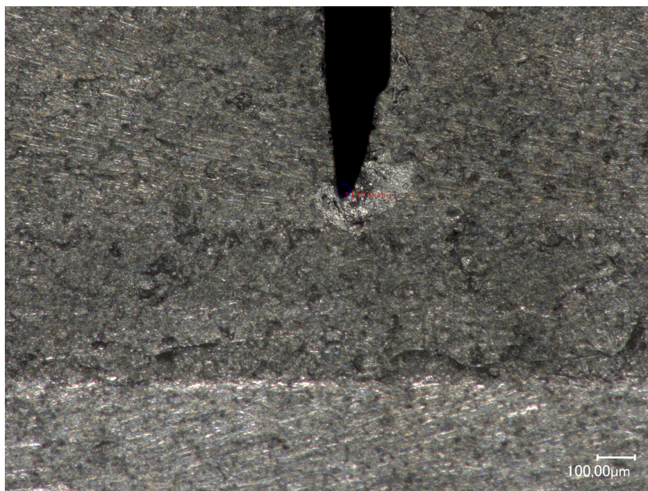
FIGURE 1.34 – Exemple d’entaille réalisée par l’entailleuse sur un échantillon de composition M3 observée au microscope numérique Keyence. Le rayon de fond d’entaille mesure ici 17.43 \mu\text{m}
