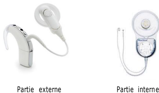
Figure 21 : Parties de l'implant cochléaire (Source Cochlear)
