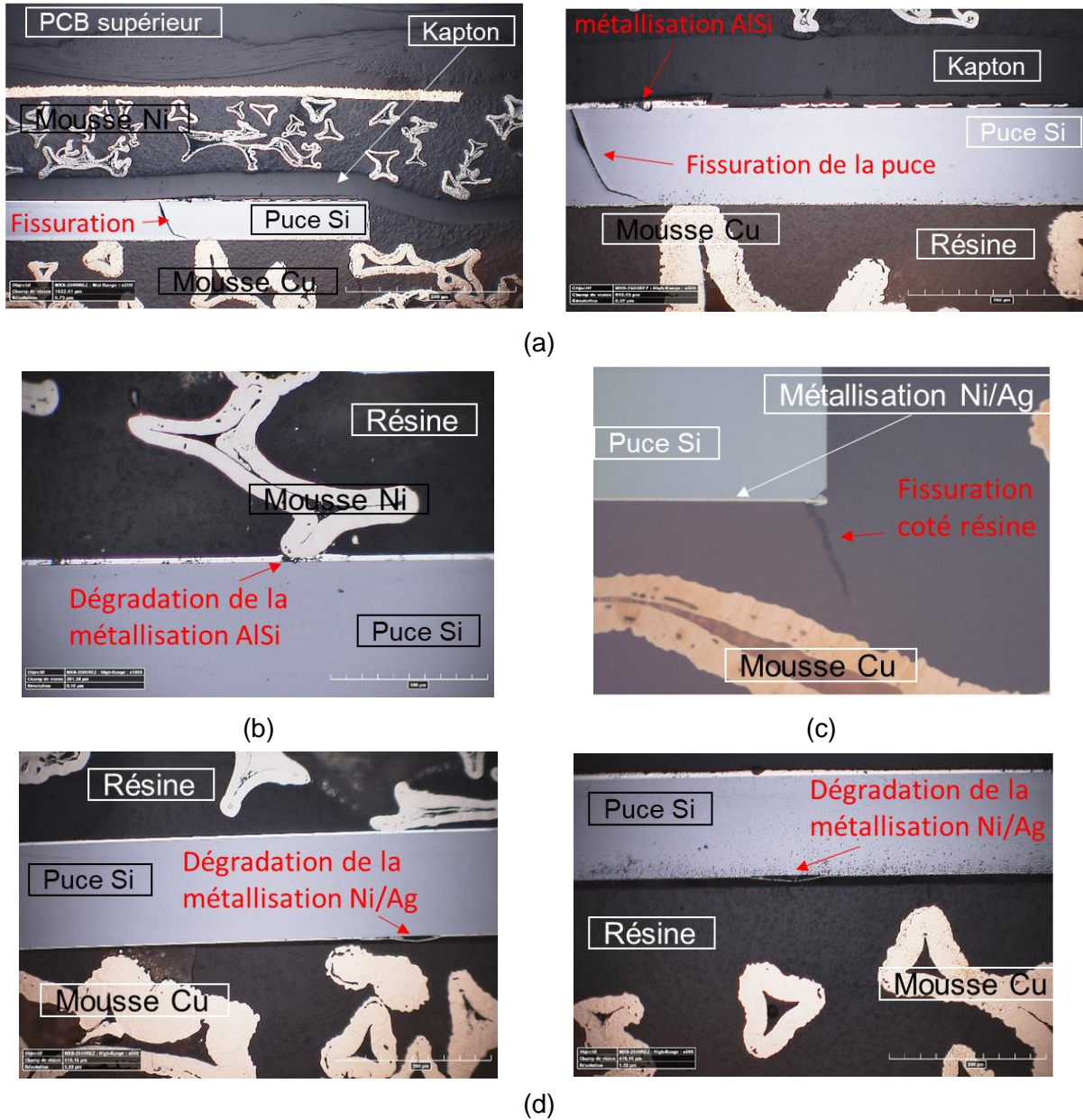
Figure 3.27 Coupes métallographique (au microscope optique et au MEB) de quelques échantillons de type (PCB_{Cu}^{Ni}) après 1000 cycles de vieillissement montrant une: (a) fissuration au niveau de la puce, (b) dégradation de la métallisation aluminium sur la face avant de la puce, (c) fissuration au bord de la puce, côté résine, (d) dégradation de la métallisation Ni/Ag sur la face arrière de la puce, [Essai #2].
