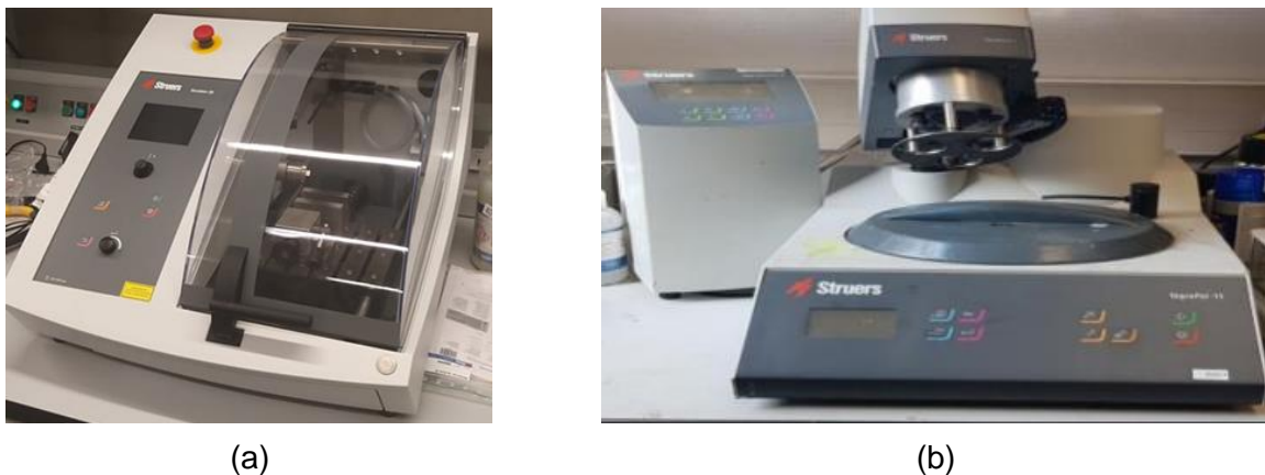
Figure 3.8 (a) Tronçonneuse Secotom-20 STRUERS, (b) Polisseuse automatique TegraPol-11 STRUERS.
