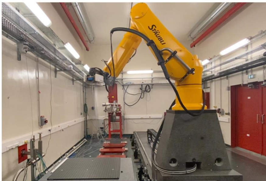
Figure 2.14 : Vue d'ensemble de CX1 actuellement en construction. Un bras robot permet de porter et d'orienter un détecteur 2D.
